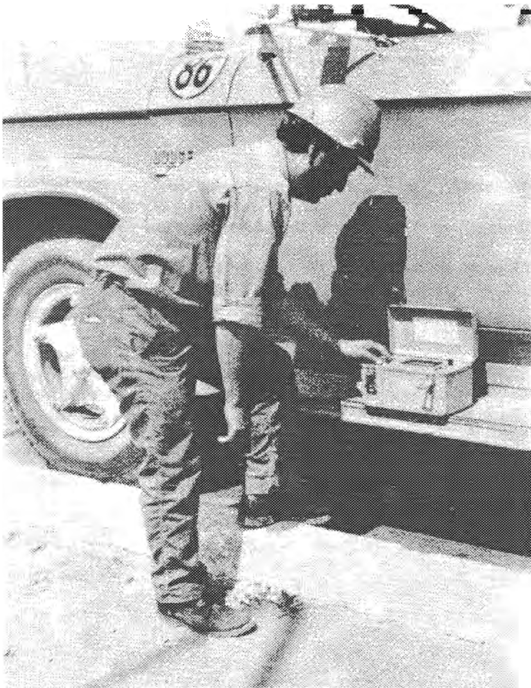
Fig. IV-1 Operario midiendo la resistividad del agua
