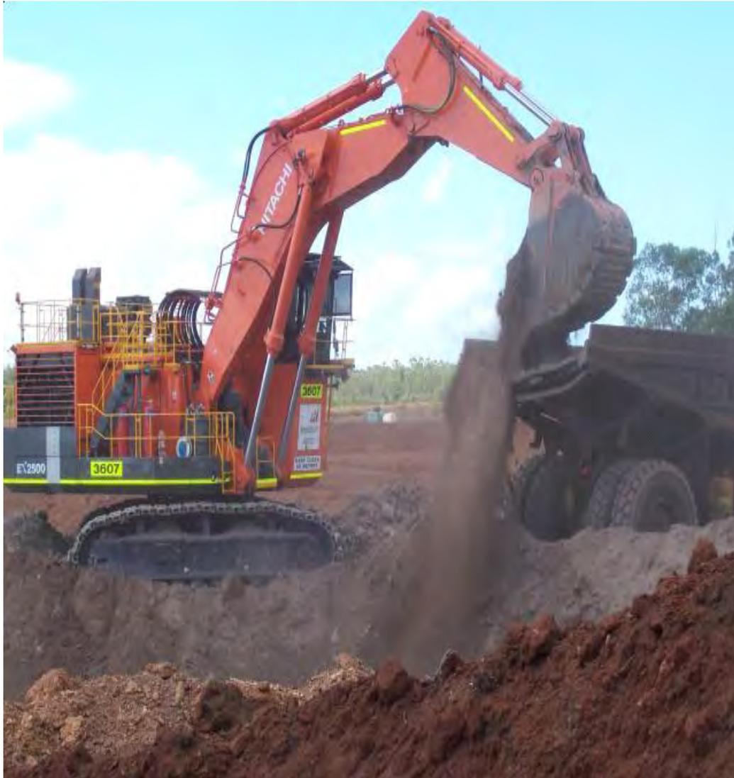
Figura 70: Pala Hidráulica Hitachi EX2500
