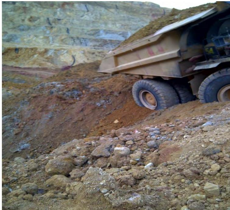
Figura 95: Camión enfangado en zona de descarga
