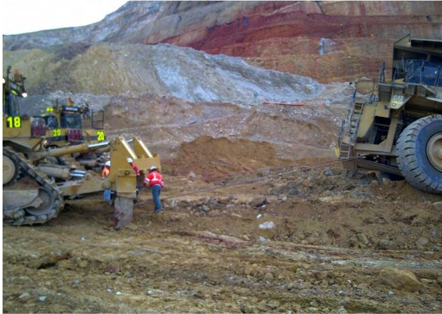
Figura 94: Rescate de camión atrapado en zona de descarga
