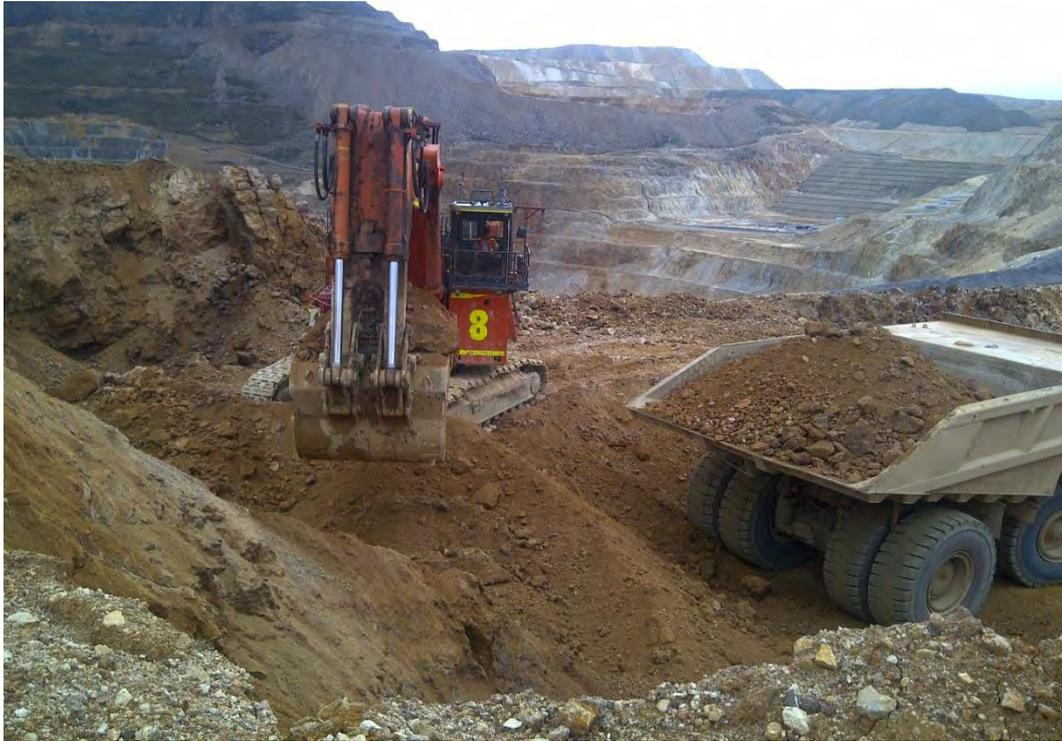
Figura 29: Camión siendo cargado por Excavadora
