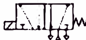
Figura 2.20, Válvulas proporcionales. Permiten regular el caudal que pasa a través de ellas
