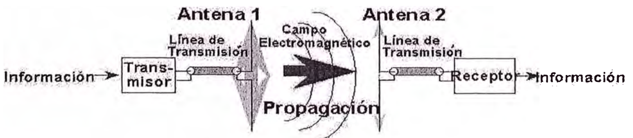
Fig. 1.15 Elementos de Radio Enlace
