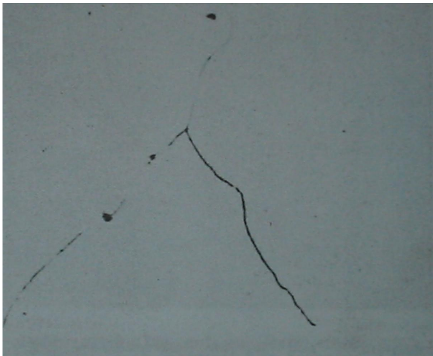
Ilustración 16. Microestructura del acero al manganeso (13%) con TT. 500X.
