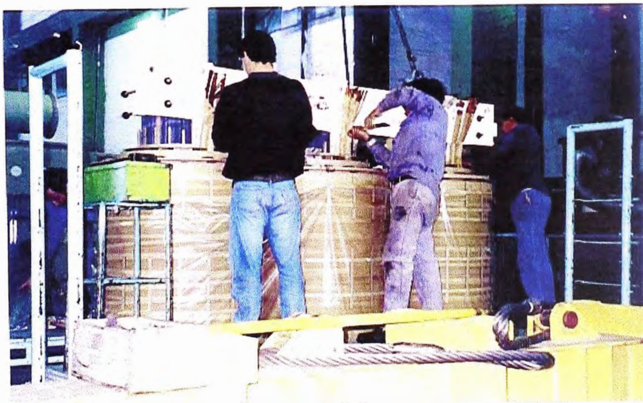
Fabricación de Bobinas de Transformador 25/30 MVA.
