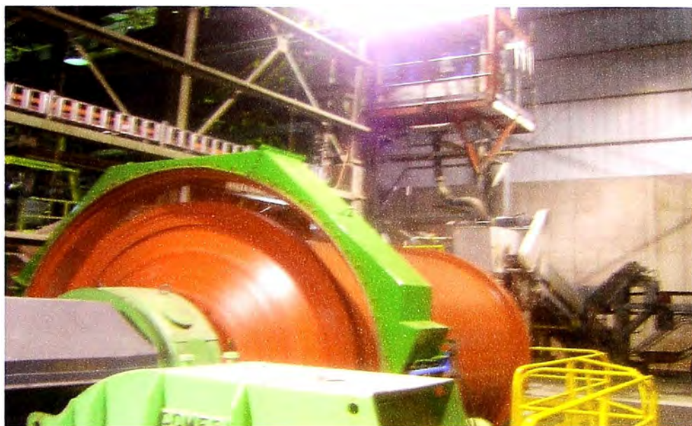
Fig. N° 08: Nuevo molino 9 ½' x 12', para el tratamiento de 1750 t/ día
