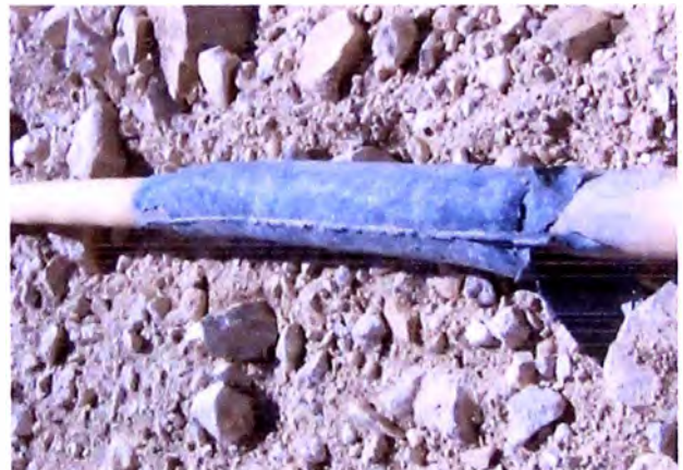
Se evitará en todo momento manipular un cable en el sector donde este tenga parches.
