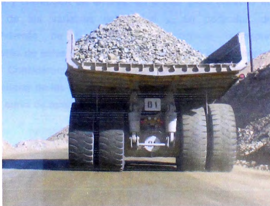
Volquete mal cargado (Poca carga y descentrada)
