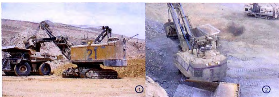
Tipos de carguío. (1) A un solo lado (2) A ambos lados.
