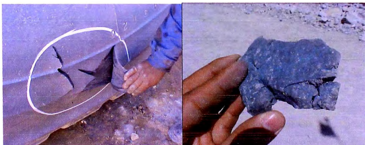
Corte en Flanco y pedazo de caucho resultado de la abrasión.
