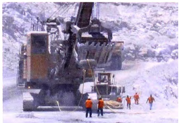
Durante un traslado de pala o perforadora es importante la coordinación entre compañeros para ordenar el cable en la cuna en forma de "ochos" cuidando que el equipo auxiliar no lo pise ni lo estire.
