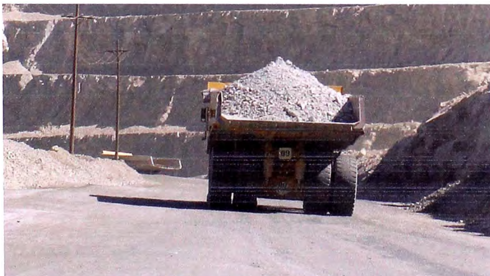
Volquete bien cargado (Carga bien distribuido)
