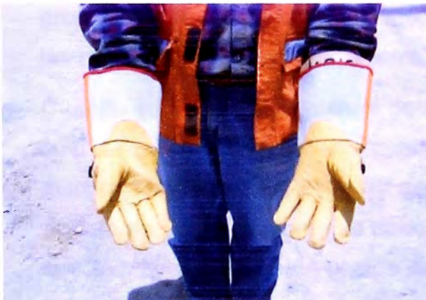
Es obligatorio el uso de los guantes dieléctricos antes de manipular cables energizados.
