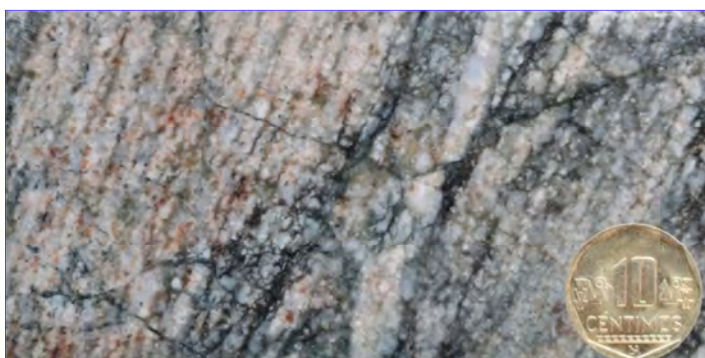
Figura 3.3 Muestra PT-05 proveniente del sondaje diamantino 4ZK-161, extraído a 670.5 m de profundidad, clasificada como gneis sienogranítico.
