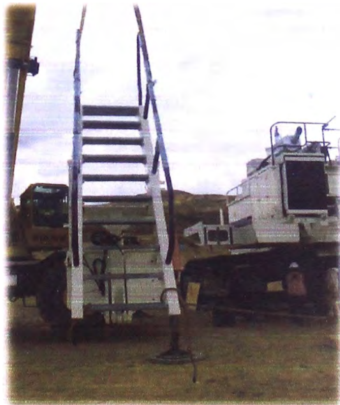
Fig. 4.8: Izando la Escalera Hidráulica
