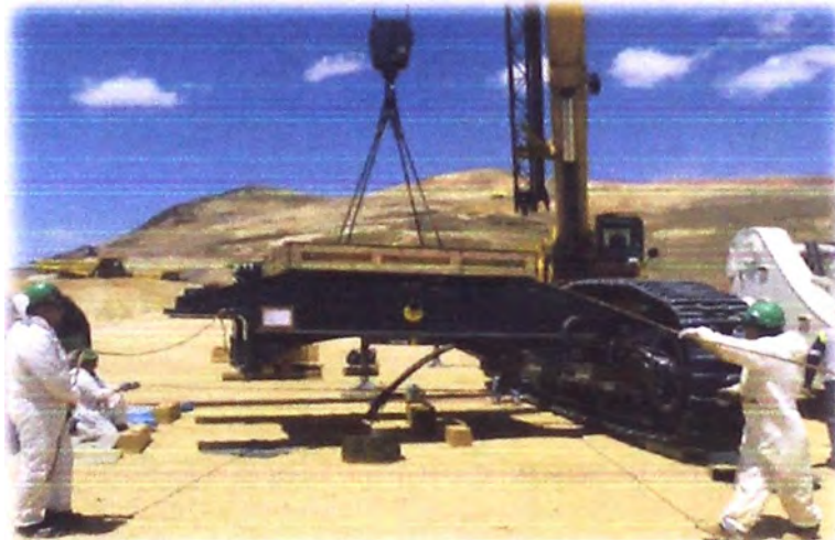
Fig. 4.3: Aproximando el Chasis Inferior hacia la Oruga Derecha
