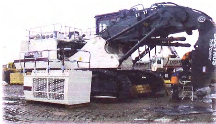
Fig. 2.33: Módulo de Enfriamiento al lado de la pala hidráulica
