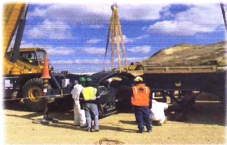
Fig. 4.4: Aproximando la Oruga Izquierda hacia el Chasis Inferior
