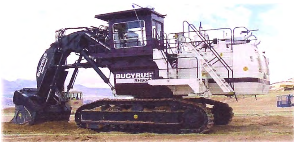
Fig. 2.1: Pala Hidráulica RH 90C / FS montada en la mina La Arena
