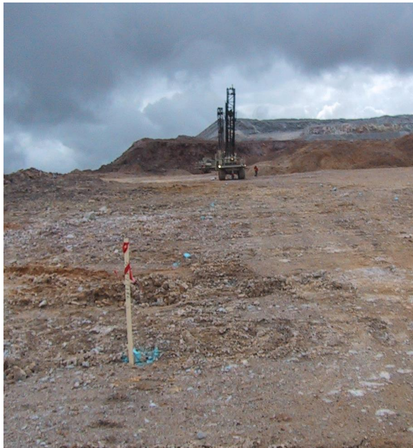
Figura 2.- Fila de perforación correspondiente a una malla
