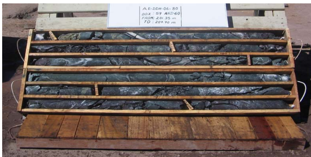
Foto 34: Caja portatestigo con cores del sondaje AE-DDH-06-80 lista para ser llevada al área de logueo y posteriormente al core shack (bodega de almacenaje) para su corte y muestreo.
