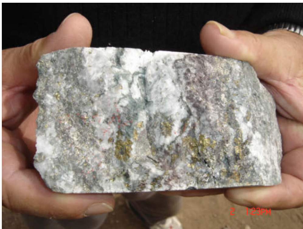
Foto 04: Muestra de core del sondaje 56 en Atenea. Obsérvese la textura de brecha con presencia de clorita más epidota y con pirita y calcopirita en la matriz. Véase como el cuarzo – sericita alberga a los sulfuros.
