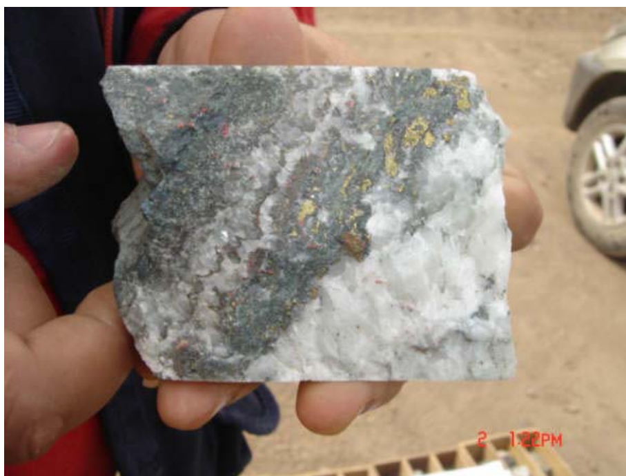
Foto 11: Muestra de de core del sondaje 56 de Atenea en la que se aprecia bandas de cuarzo con pirita y calcopirita; los análisis de laboratorio dieron como resultado leyes de 152.9 Au gr/TM, 1320 Ag gr/TM y 12.5% Cu.
