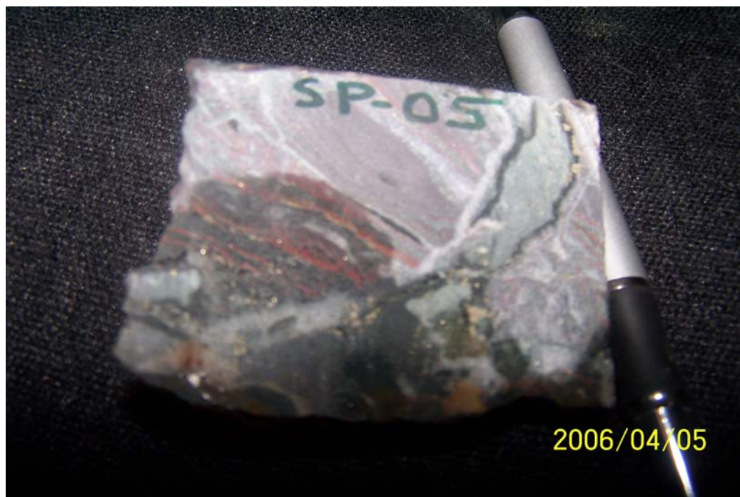
Foto 12: Muestra de mano de la veta Atenea en las que se aprecian bandas de hematita cortadas por venillas de cuarzo. Oro libre ha sido hallado en la matriz silícea.
