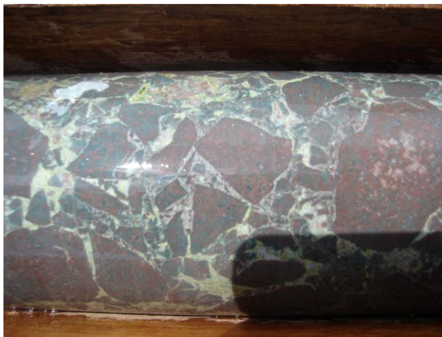
Foto 29: Core de la veta Atenea en donde se aprecian fragmentos angulares de brecha en una matriz de cuarzo – calcita y sulfuros.
