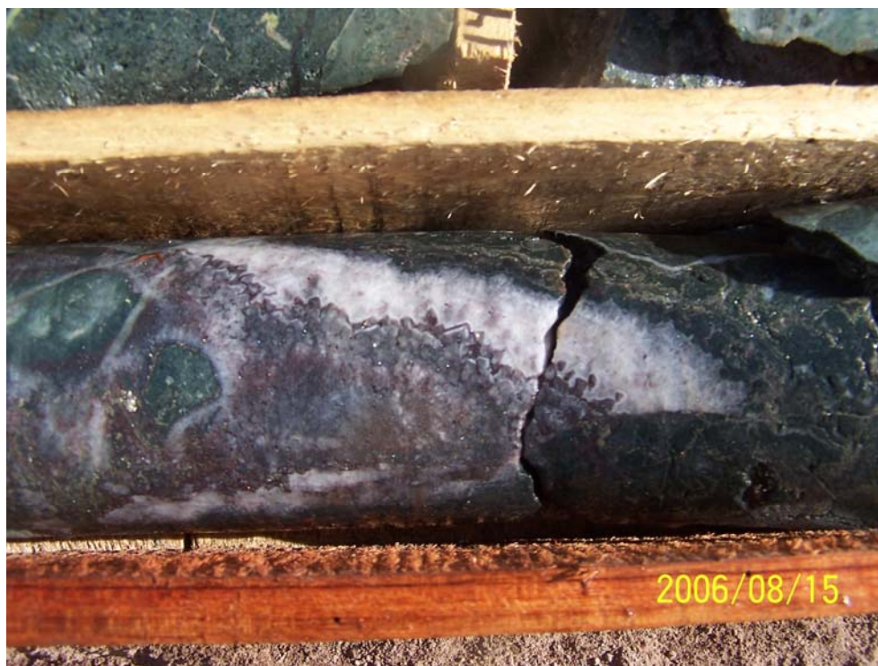
Foto 32: Core del sondaje AE-DDH-06-56 en el que se aprecia como el cuarzo y los sulfuros masivos han rellenado los espacios dejados por el brechamiento de la roca pre existente.
