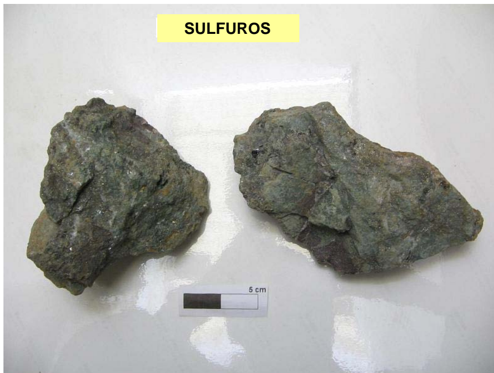
Foto 31: Brecha andesítica con relleno de sulfuros en las fracturas.
