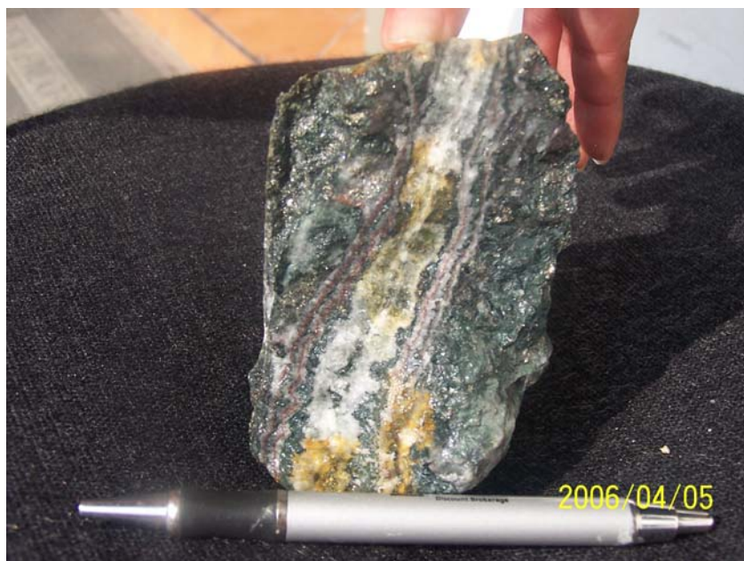
Foto 09: Muestra de mano de la veta Atenea, se aprecia cuarzo bandeado con capas de hematita cortando la clorita masiva con pirita y en menor proporción calcopirita.
