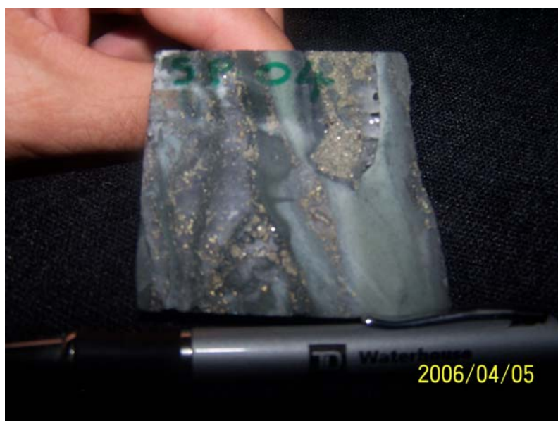
Foto 08: Muestra de mano de la veta Atenea, calcedonia englobando agrupaciones de pirita; análisis microscópico de esta muestra detectó la presencia de oro libre en la pirita.
