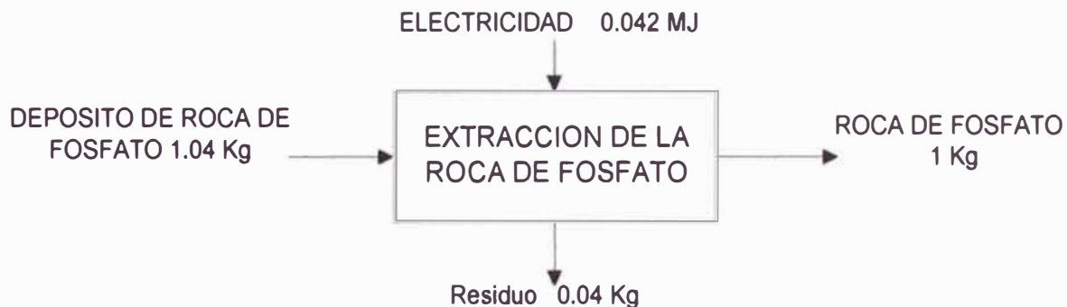
ENTRADAS Y SALIDAS PARA LA EXTRACCION DE LA ROCA DE FOSFATO
