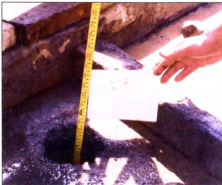
Medición de la profundidad del pozo perforado
