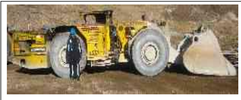
Fig 06 A Scooptram Modelo ST-1030 de 6yd3
