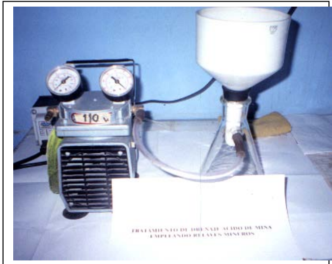
Foto 8 Equipo de filtro al vacío
