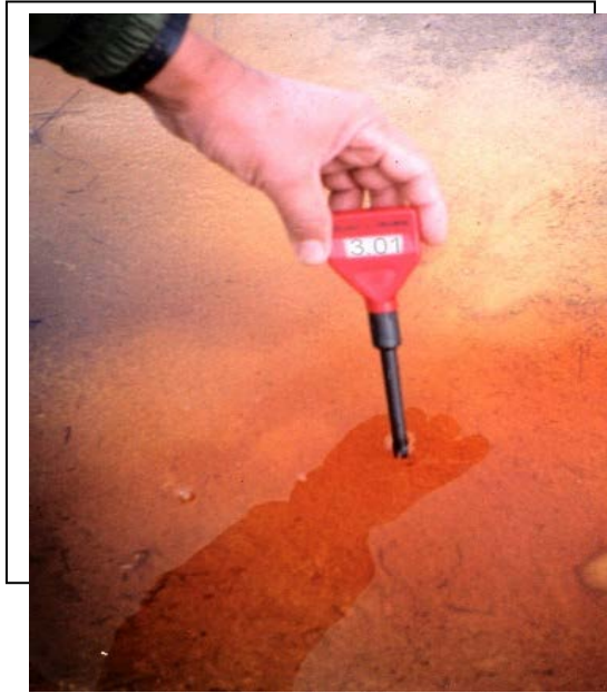
Foto 6 Medición del pH del efluente ácido
