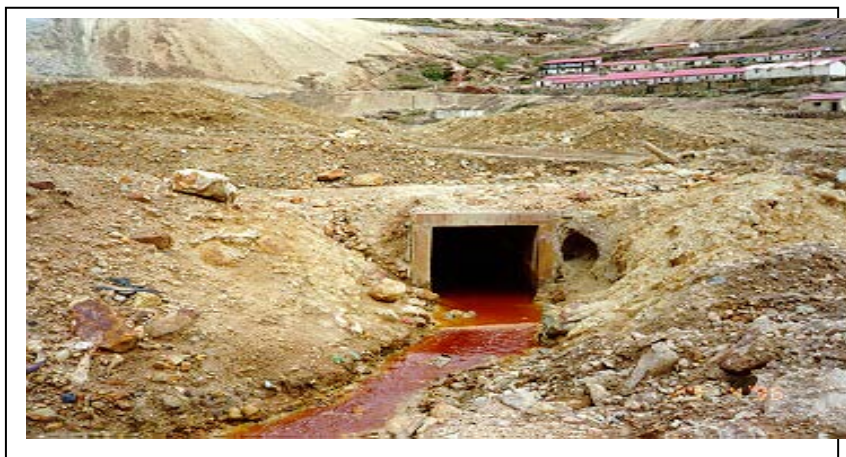
Foto 3 Drenaje ácido de mina en los Andes - Perú
