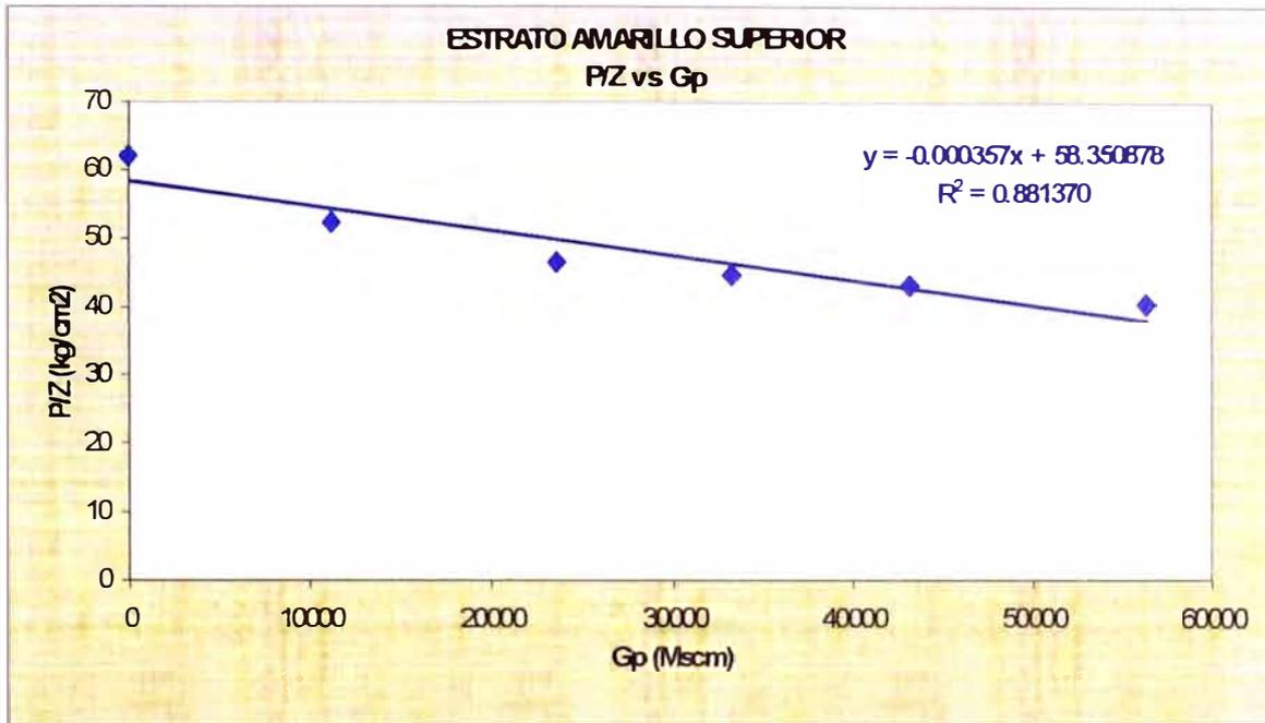
Figura 4.5.13 Balance de Materiales del Yacimiento para el Estrato Amarillo Superior, Método p/z
