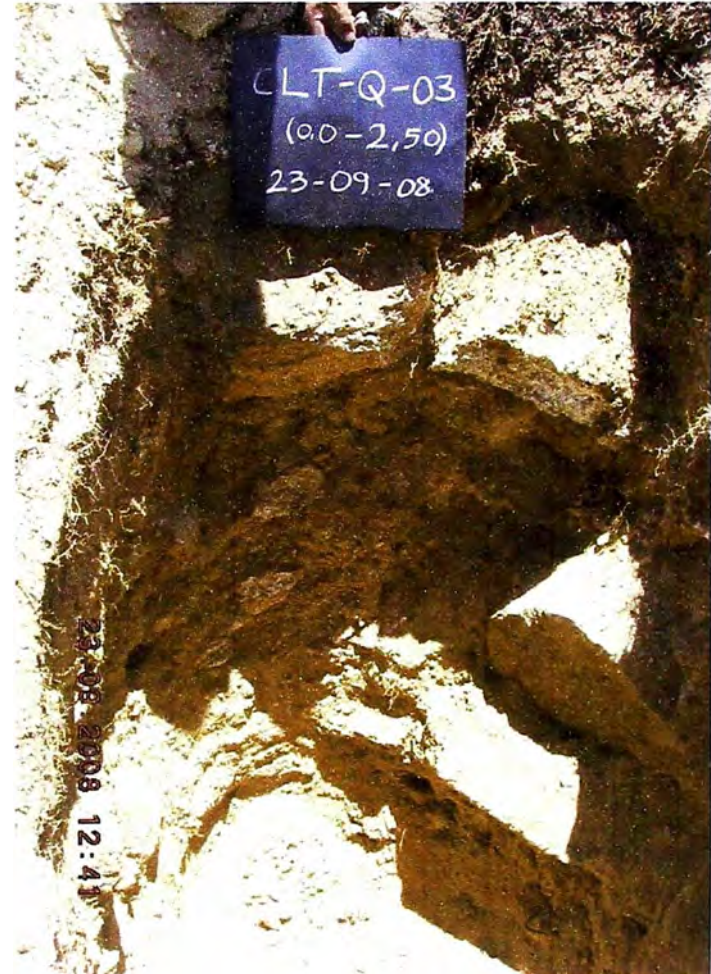
Foto N° 04.- Calicata CLT-H-03, obsérvese los fragmentos rocosos heterométricos, angulosos a sub-angulosos, de 6" – 30", de diámetro. Se presentan alterados y muy fracturados, sobre una matriz areno limosa.
