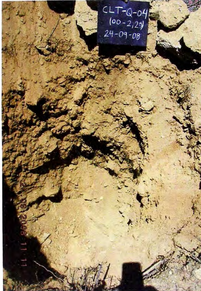
Foto N° 05.- Calicata CLT-Q-04, excavado en el vértice V-3B, mezcla heterogénea de gravas y arenas, de color marrón claro, de baja compactad, engloba fragmentos rocosos sub-redondeados con diámetro de hasta 10" en un porcentaje estimado del 60-70%.
