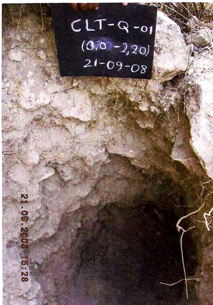
Foto N° 01.- Calicata CLT-Q-01, excavado en el Vértice V-9B, los suelos son de compacidad media, constituidos por arenas y limos, engloba fragmentos heterométricos angulosos a sub-angulosos de 6"-12" de diámetro.
