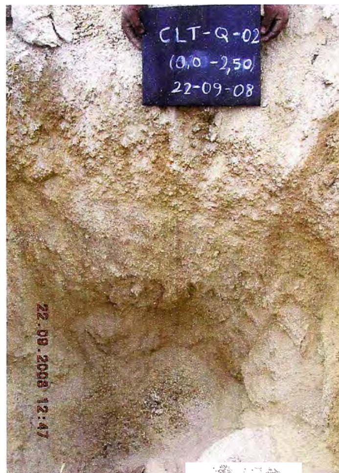
Foto N° 02.- Calicata CLT-Q-02; los suelos están constituidos por una Mezcla heterogénea de gravas, arenas y limos color beige claro, de compacidad media, secos, con fragmentos rocosos sub-redondeados, poco alterados.
