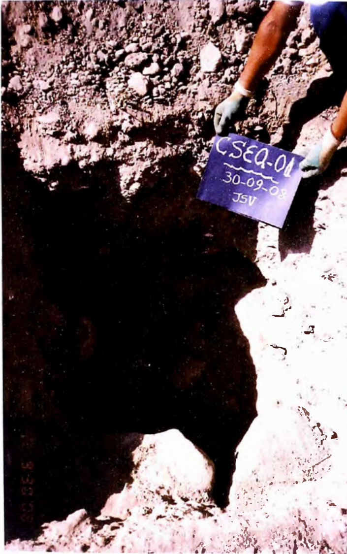
Foto N° 10.- Calicata CSE-Q-01 (V-1A), excavada en la S.E. Quitaracsa.
