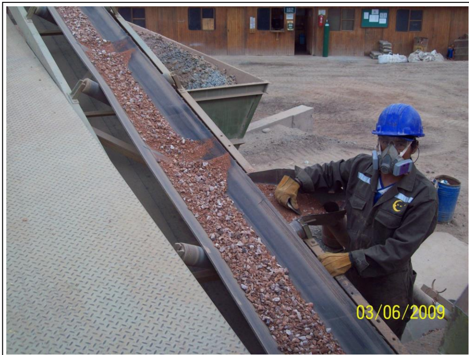
Foto 2.2-6: Muestreo manual en faja a 1.20m de distancia entre corte y corte
