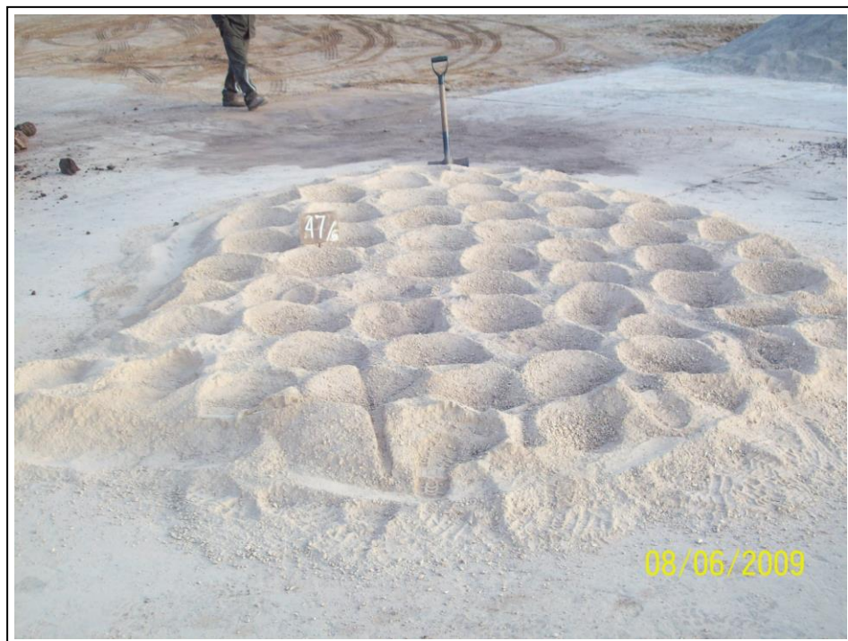
Foto 2.2-12. Lote de oxido muestreado por puntos, luego de ser chancado en un circuito abierto
