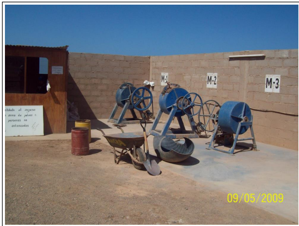
Foto 2.2-15. Molinos polveadores de 30 Kg de capacidad, el mineral muestreado se “polvea” para su cuarteo final
