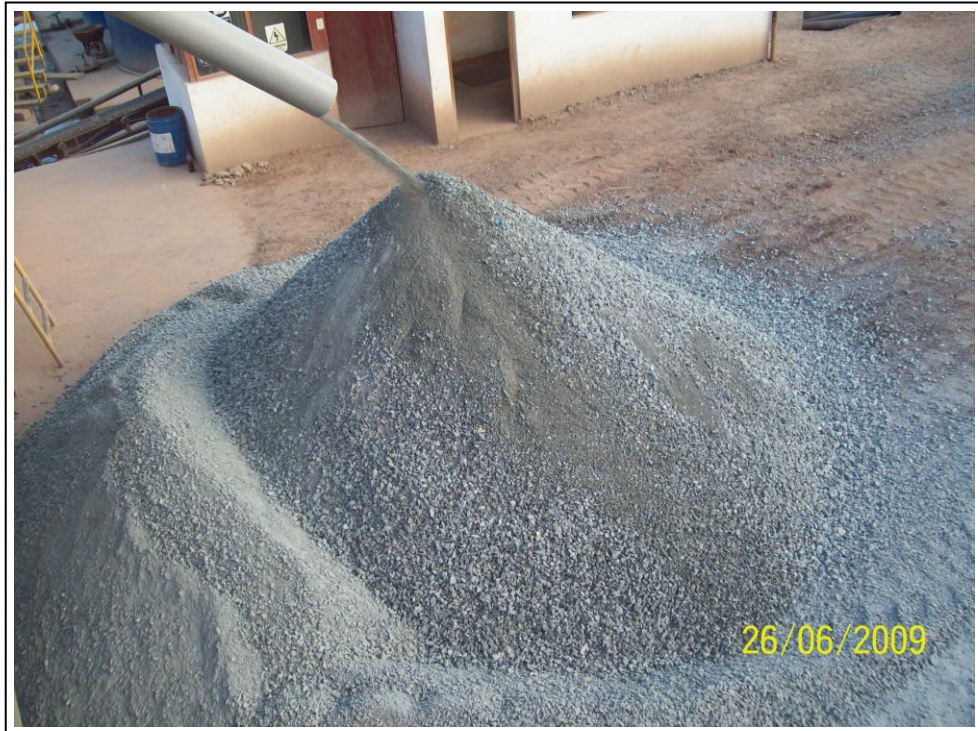
Foto 2.2-5. Producto Final del chancado, se evacua el lote entero antes de muestrear, estos lotes son mayores a 100TM
