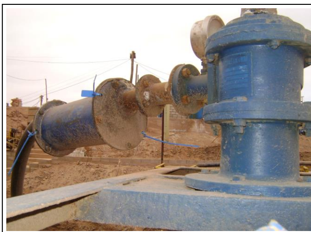
Foto 2.2-26,27. Trampas de Amalgama a la salida de la bomba y al ingreso del hidrociclón
