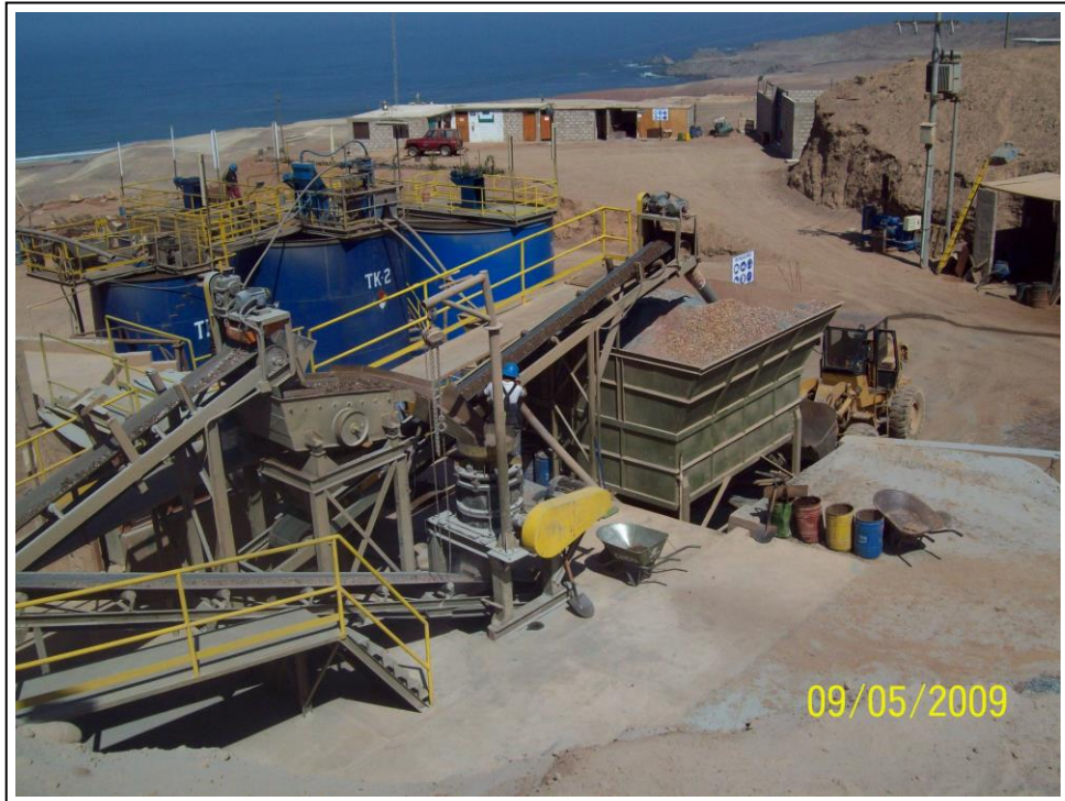
Foto 2.2-17. Vista general del circuito de chancado principal, fajas, chancadoras, tolvas y cargador frontal
