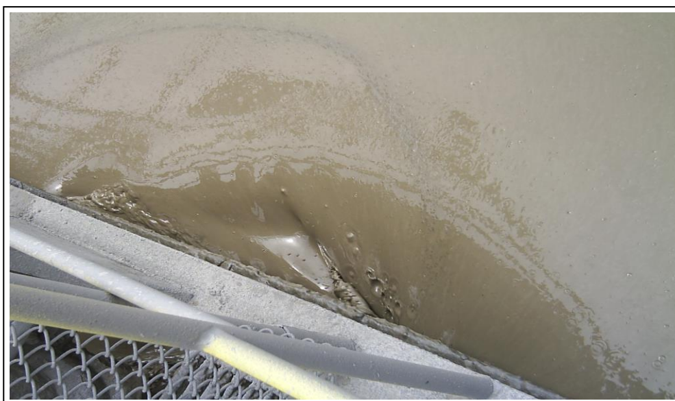
Foto 3.3-4. Superficie de tanque 12'x12', la pulpa recirculando por el Draft, se pueden ver las burbujas de aire que ocasiona esta forma de agitación.
