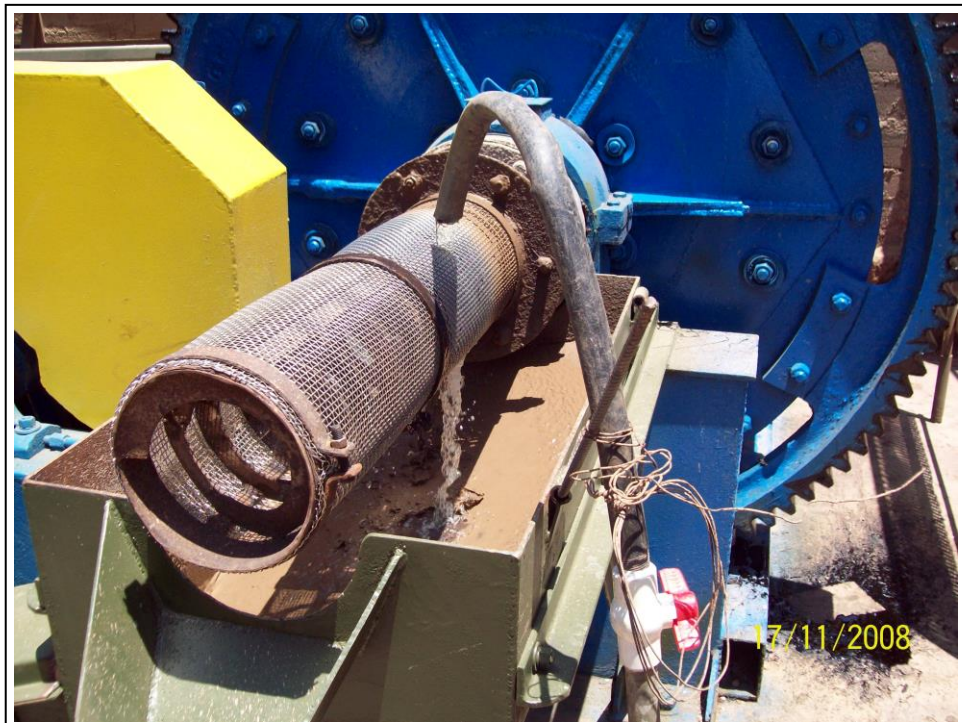
Foto 2.2-21,22. Molino Denver 5'x5', cuenta con un trommel que permite eliminar los gruesos y limpiar la pulpa, con este molino se amplio la capacidad a 50 TMSD, asimismo se montaron dos tanque de 18'x18' y se alargo un tanque 12'x12' a 18', con estos 5 tanques se tenia un tiempo de retención de 104 horas
