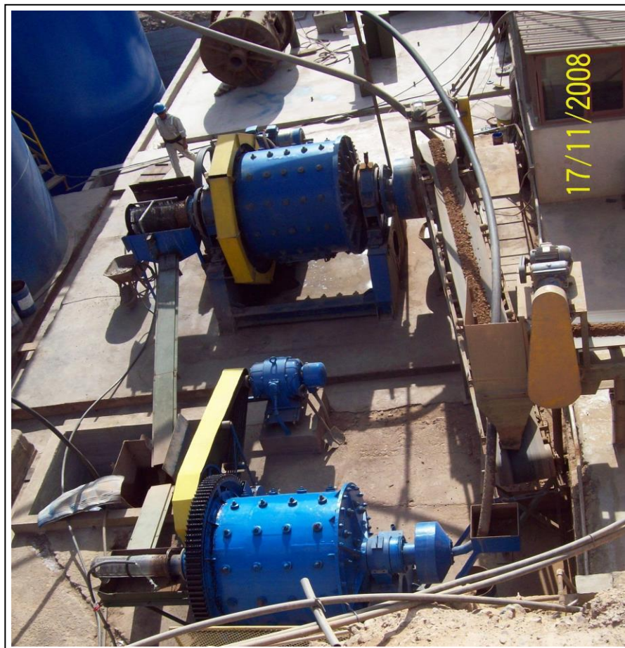
Foto 2.2-23,24. Molinos 5'x5' y 4'x4', con estos dos molinos se subió la capacidad a 80TMSD, ambas descargas se colectan con canaletas hacia una bomba y hidrociclón que recircula la carga a ambos molinos, variando la relación de carga circulante se llegó a subir de 70 a 85 TMSD, manteniéndose actualmente en 80TMSD, se observa el tercer molino Grieve 5'x5' que está montando actualmente.
