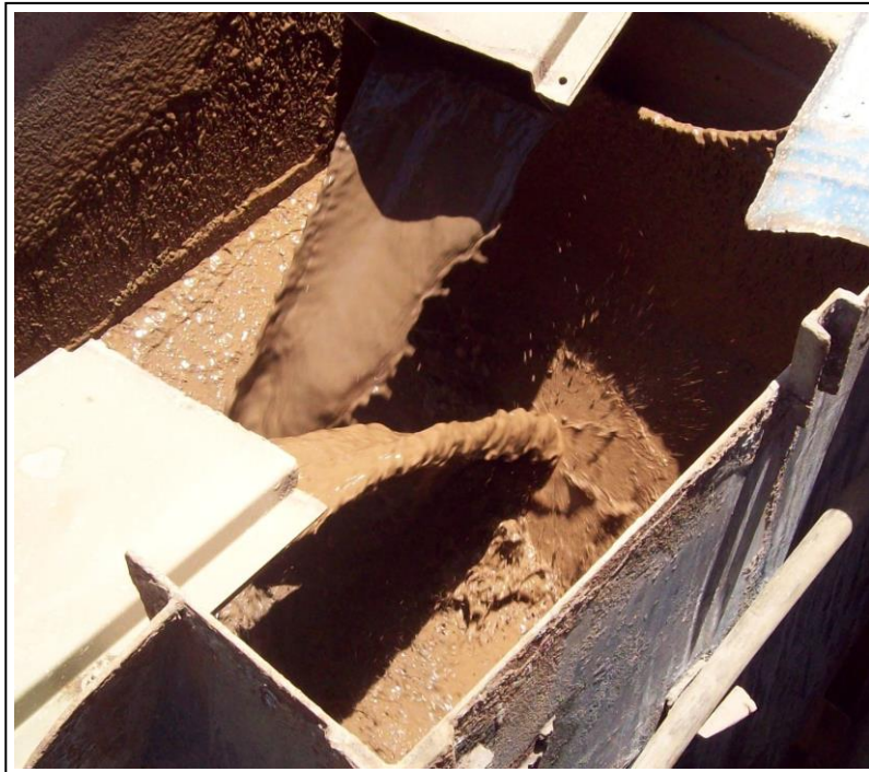
Foto 3.3-6. Caja de bomba, aquí se recolecta las pulpas de los dos molinos, estas pulpas están siendo aireadas indirectamente.
