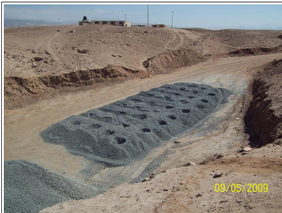
Foto 2.2-14. Lote de sulfuro de 100TM muestreado por hoyos, el siguiente muestreo se realiza por puntos
