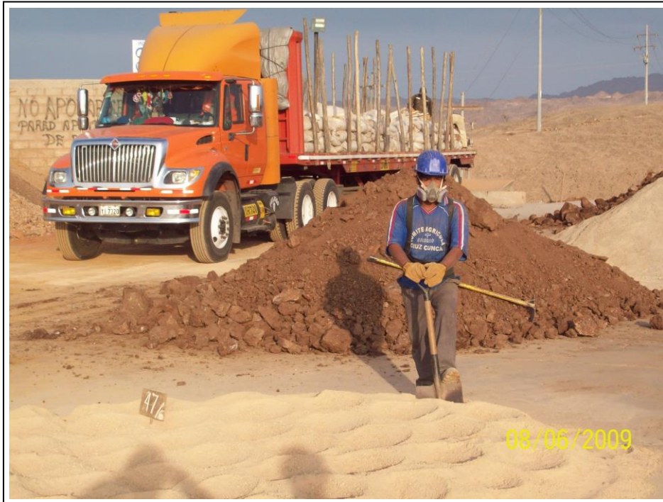
Foto 2.2-13. Lote descargándose directamente a la tolva de grueso(30TM), otro lote en la cancha de gruesos a la espera de ser chancado en el circuito principal que el cargador frontal alimentara y un tercer lote de mineral zarandeado muestreado por puntos
