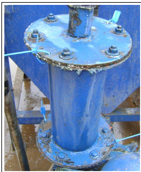
Foto 2.2-26,27. Trampas de Amalgama a la salida de la bomba y al ingreso del hidrociclón
