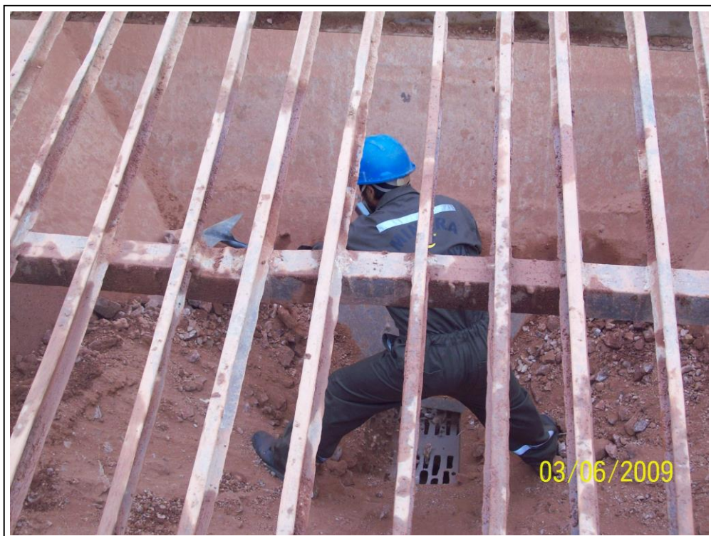
Foto 2.2-4. Tolva de Gruesos y las parrillas de 6" de luz, personal acabando el chancado, realizando limpieza
