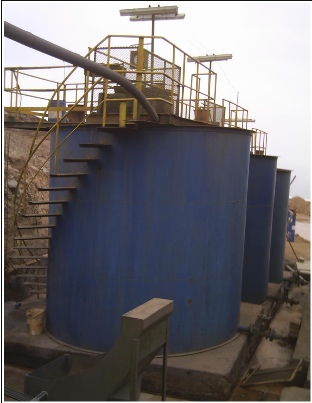
Foto 2.2-20. Los 3 tanque 12'x12', para la capacidad inicial de 25 TMSD se tenía un tiempo de retención de 55 horas, la descarga del carbón se realiza vaciando el tanque completamente luego de 30 horas de cianuración batch, para poder evacuar la pulpa al tanque N° 2, Se observa el DSM en el piso que se utilizaba para lavar el carbón cargado
