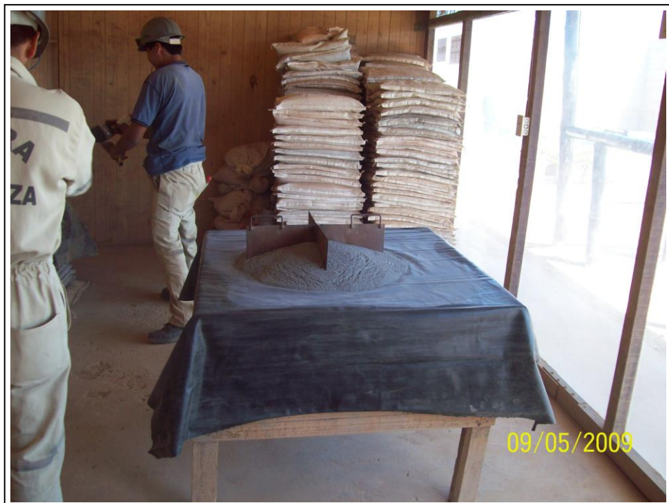
Foto 2.2-16. Mineral polveado al momento de ser cuarteado para la entrega de la muestras testigos, ultimo punto de manipuleo del mineral
