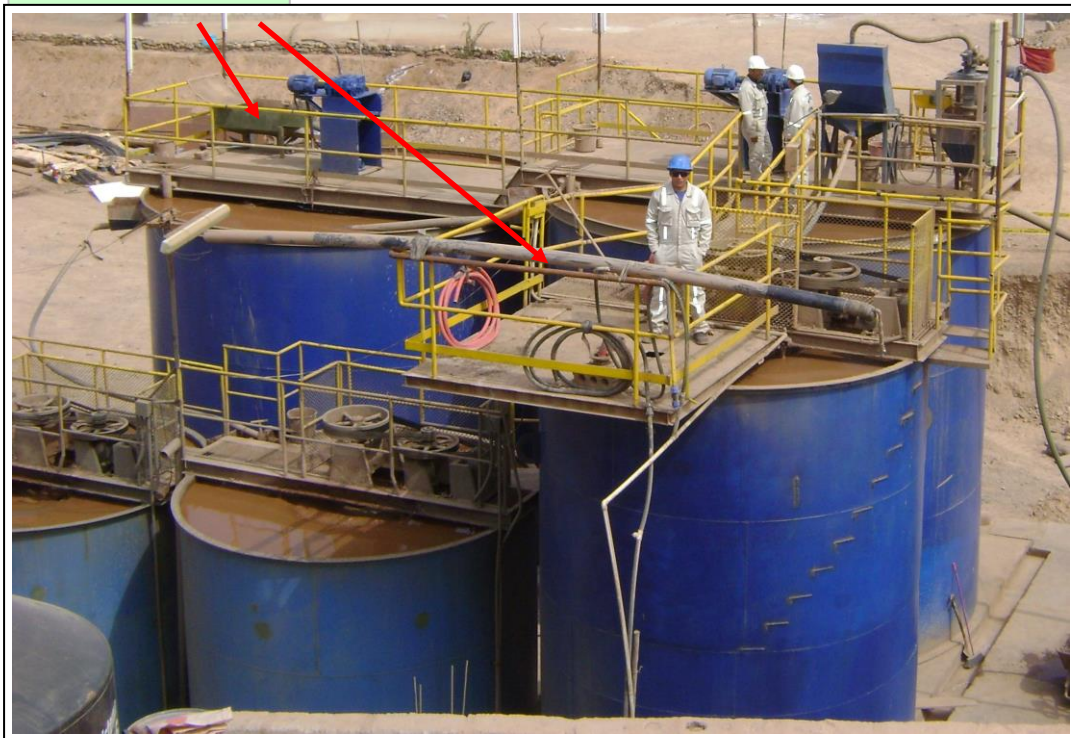
Foto 2.2-30. Tanques 12'x18' alargado, 2 tanques 18'x18' y 2 tanques 12'x12' que aun se mantenían como tanques de colas, se observa la lanza para la cosecha del carbón activado y la cosechadora plana.
