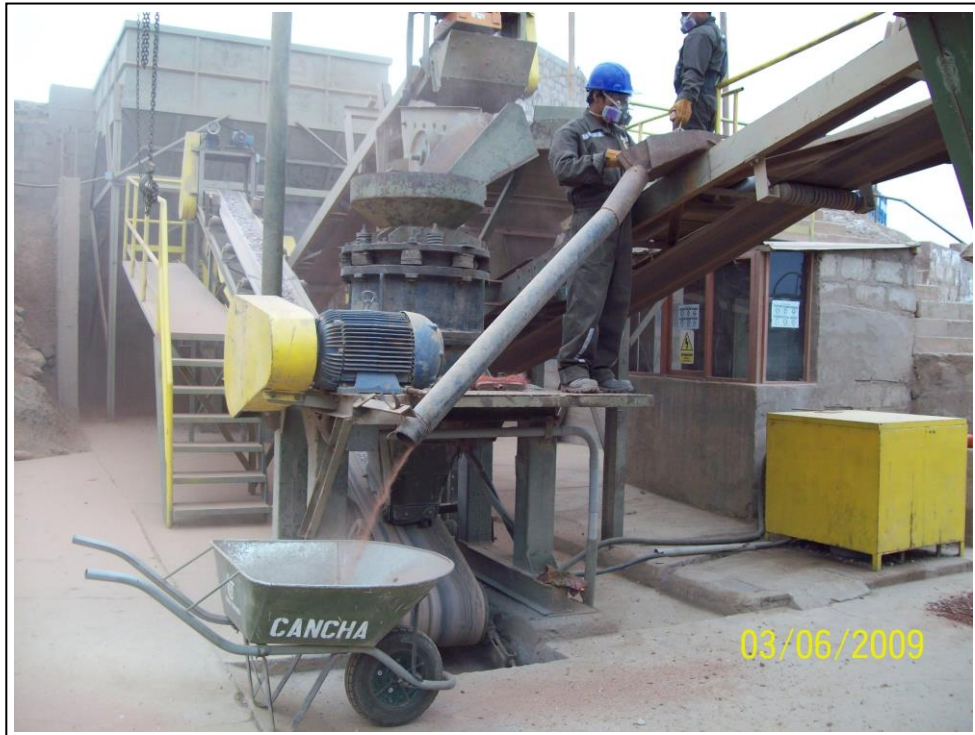
Foto 2.2-7. La muestra se toma de la faja N°3 y se deposita en carretillas para su posterior cuarteo
