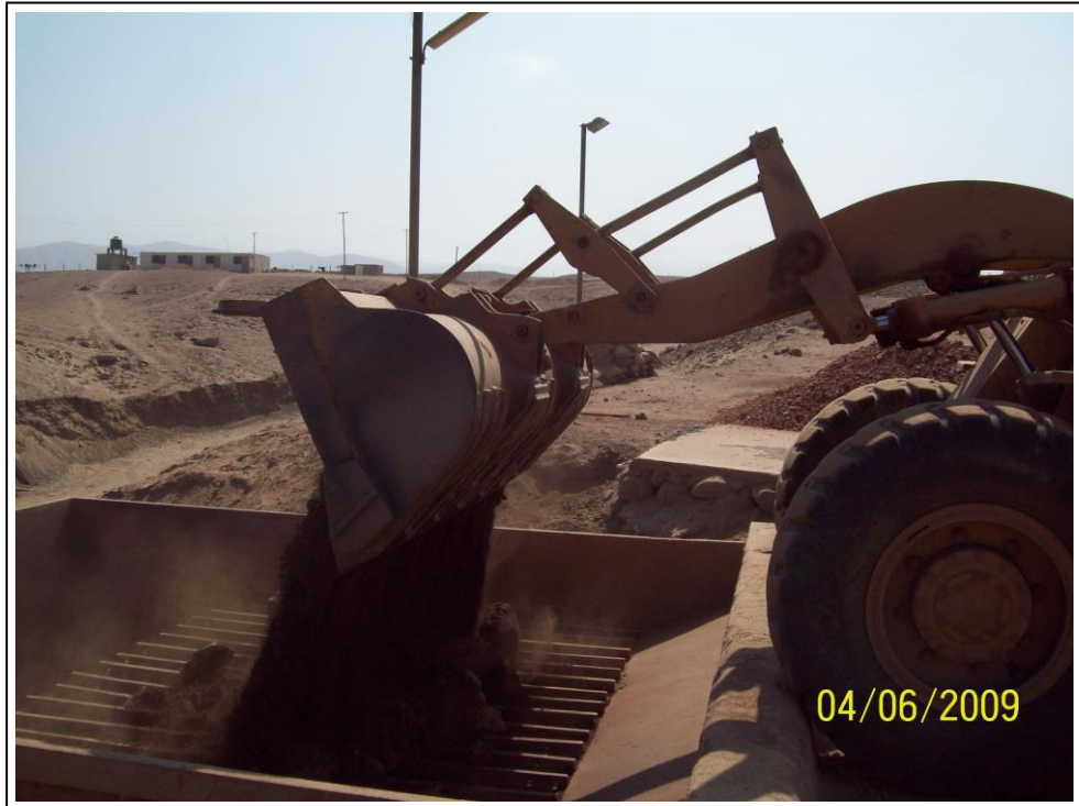
Foto 2.2-9. Ingreso de lote recepcionado en cancha, se hace cuando se reciben lotes continuados y se acumulan para su posterior chancado
