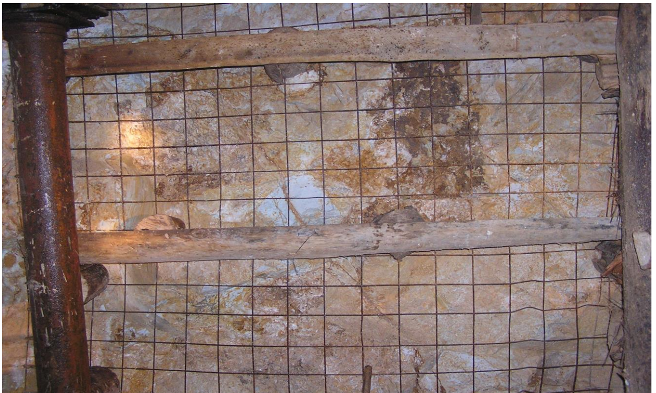
Foto 2. otro diseño de instalacion de malla es el colocado de dos rajas en los extremos y un perno swellex de 7 pies con su respectiva plantilla.
