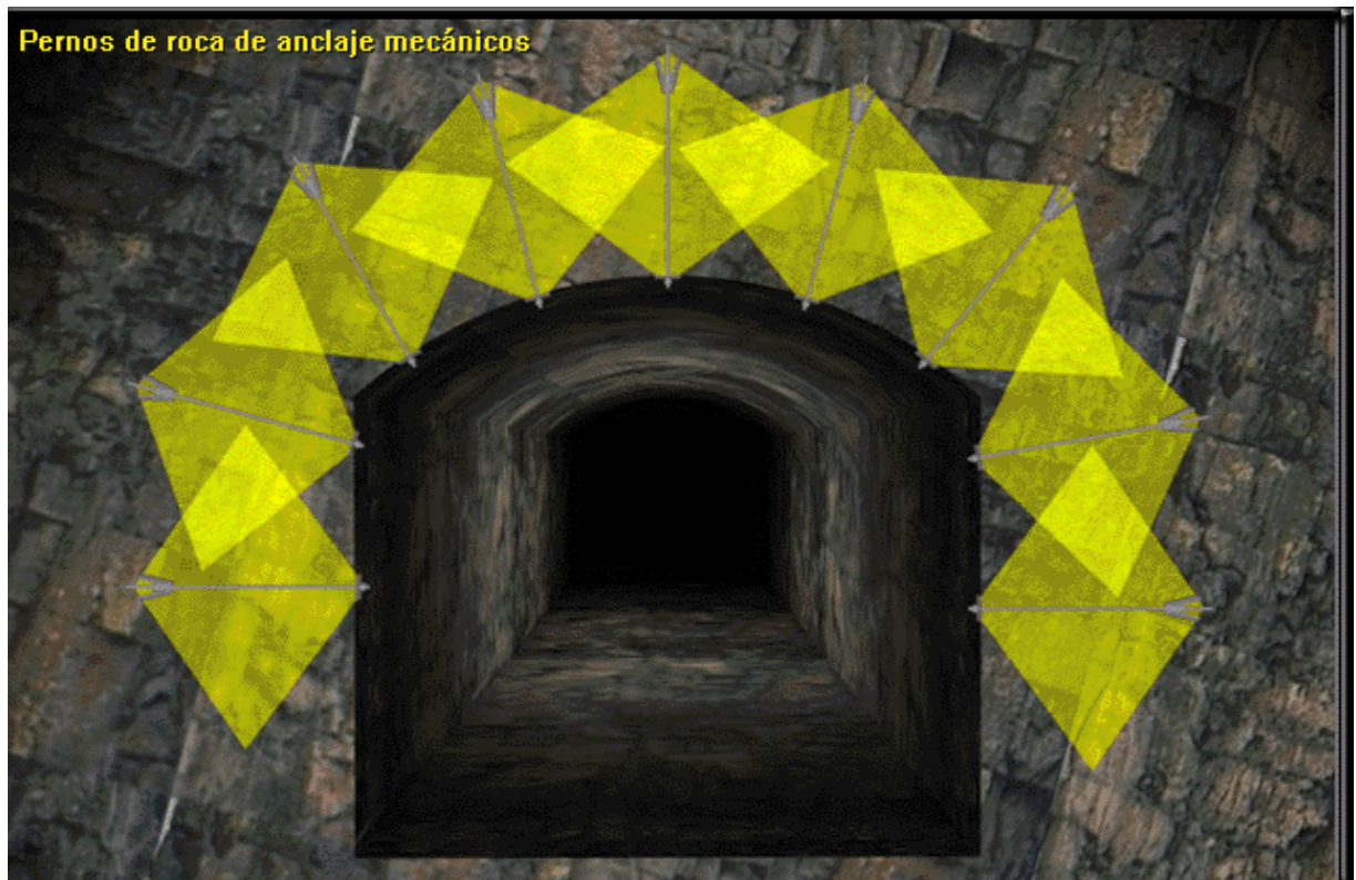
FIG 8. Comportamiento del swellex en toda su dimension después de la instalación.
