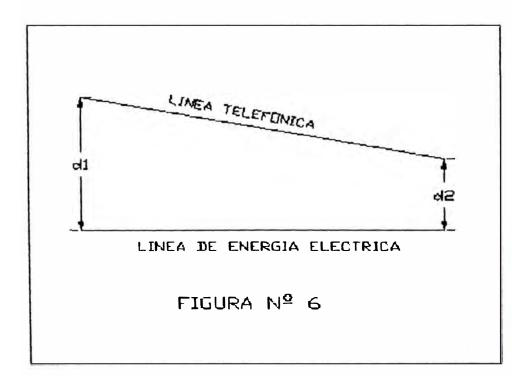
La inductancia mutua 'M' es función de la resistividad del suelo 'p' y de la separación 'd' entre las líneas de energía eléctrica y telefónica; para la frecuencia de 60 Hz, está dada en la figura del Anexo I.
