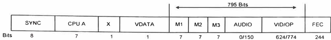
Fig. 5-3 : Trama de comunicación para 2.9 y 3.3 Mbps (baja velocidad)
