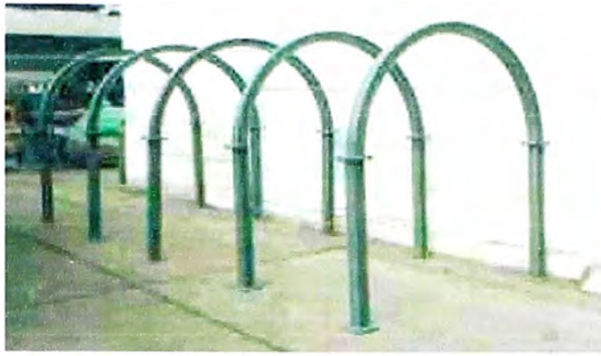
Figura 4.4.1-a Arcos para sostenimiento subterráneo
