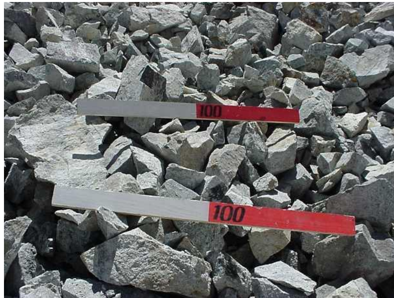
FOTO N° 26: Fotografía digital del material volado
