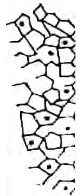
ADHESION DE CRISTALES DE CERA (DEBAJO PUNTO ENTURBIAMIENTO)
