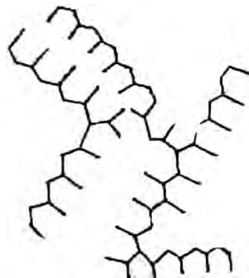
COHESION DE CRISTALES DE CERA (DEBAJO PUNTO ENTURBIAMIENTO)
