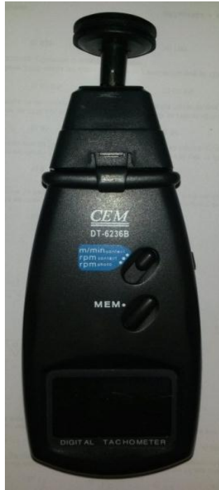
Figura 5. 4: Tacómetro digital CEM utilizado.
