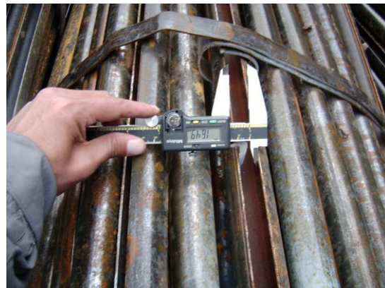
Medición de la abertura de la ranura.
