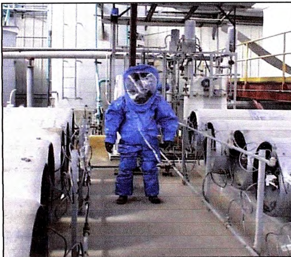
Figura 15. Traje Nivel "A" de emergencia de escapes de cloro
