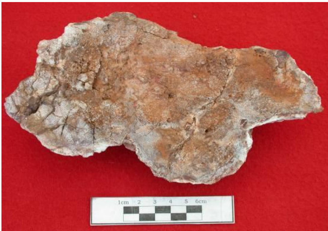
Foto. 07. Roca piroclástica mostrando una alteración argílica avanzado, ensamble cuarzo alunita. Nótese el proceso de oxidación entre el fracturamiento de la roca. Roca con 1.0 g/T Au.
