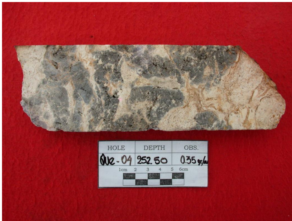
Foto C. Se observa una roca piroclástica rica en cristales, cortada por venillas irregulares de sílice alunita con escaso contenido de oro.
