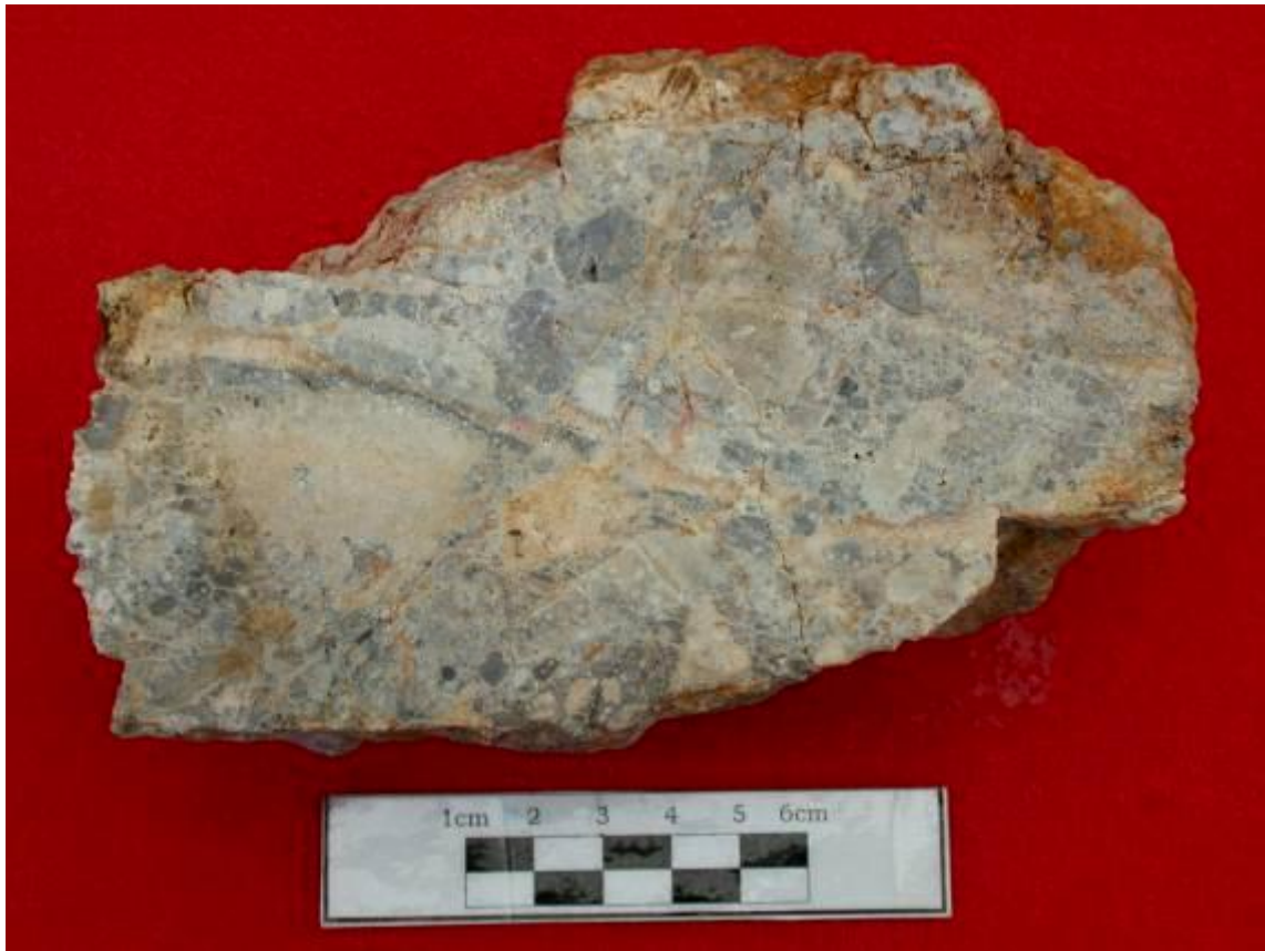
Foto. 05. Roca fragmental heterolítica, con fragmentos de sílice gris semiredondeados a subangulosos, dentro de una matriz polvo de roca y posteriormente reemplazada por alunita. Se aprecian canales irregulares de alunita asociada a la mineralización de Au. Esta roca tiene una ley de 0.82 g/t Au.
