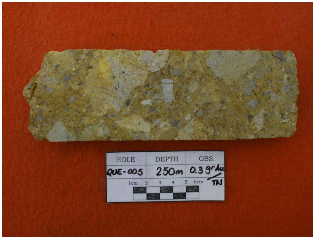
Foto D. Se muestra una brecha hidrotermal (BXH), se observa una roca con fragmentos heterolíticos y heterogéneos con una alteración sílice granular con venillas irregulares de Alunita.
