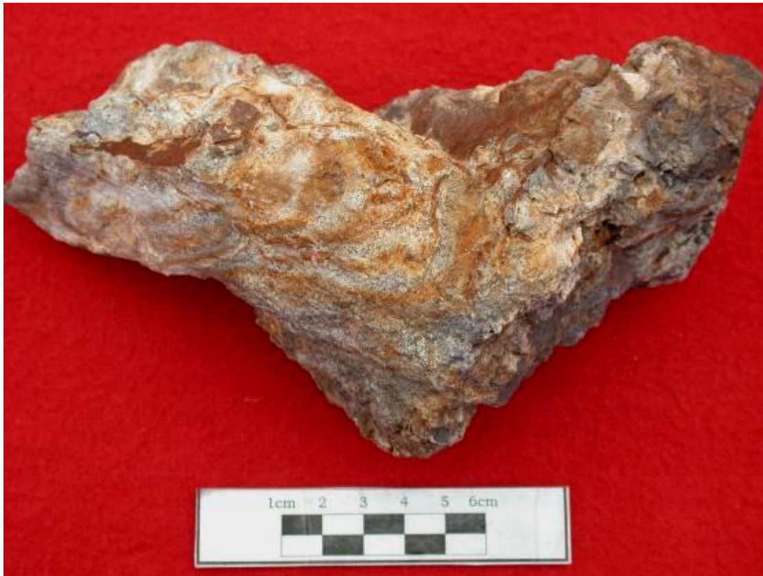
Foto. 06. Roca piroclástica cortada por venillas de SiOx acompañadas por una intensa alunitización. Roca con 1.2 g/t Au.
