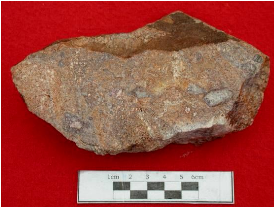
Foto. 03. Roca con fragmentos líticos (<1.5cm) dentro una matriz con cristales rotos, secuencia piroclástica de tufos líticos en Quecher.
