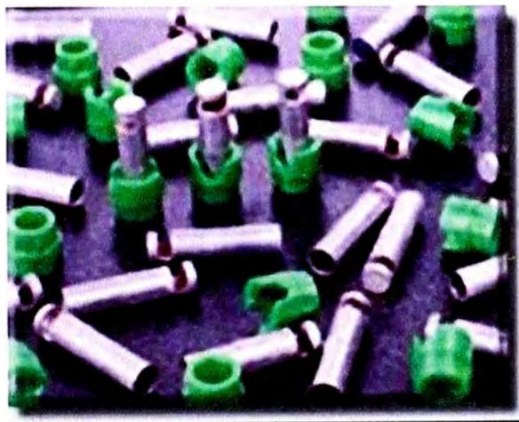
Esta conformado por un casquillo cilíndrico de aluminio cerrado en uno de sus extremos, en cuyo interior lleva una carga pirotécnica sensible a la llama producida por la mecha rápida, además el casquillo tiene una ranura paralela y cercana a la base por donde se inserta la mecha rápida.
