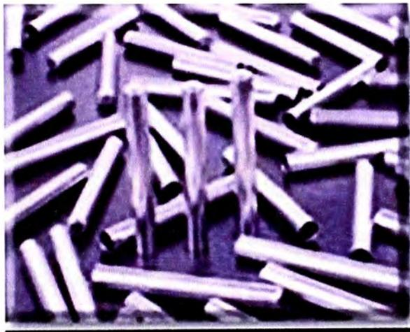
Esta conformado por un casquillo cilíndrico de aluminio cerrado en uno de sus extremos, en cuyo interior lleva una carga primaria de un explosivo sensible a la chispa y otra carga secundaria de alto poder explosivo. Su diseño permite que la carga primaria sea activada por la chispa de la mecha de seguridad, la cual inicia la carga secundaria.
