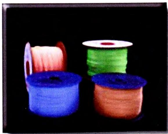
Es un accesorio para voladura constituido por un núcleo granulado fino y compacto de pentrita PETN (pentaerythritol tetranitrate) que está recubierto con papel de características especiales, fibras sintéticas, hilos de algodón. Su cobertura exterior varía según el cordón sea simple o reforzado.
