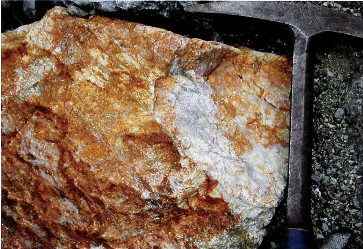
**Foto 03** :Rodado de monzonita alterada, brechada con venilleo de cuarzo; pirita, calcopirita y calcosina diseminada 2259 ppm @ Cu.
