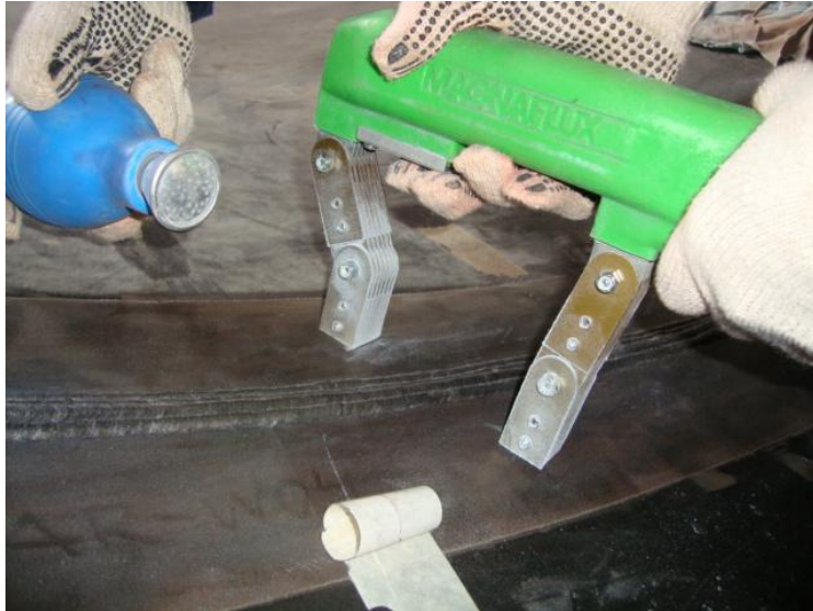
Fotografía N° 5.5 Inspección de posible fisura con partículas magnéticas.
