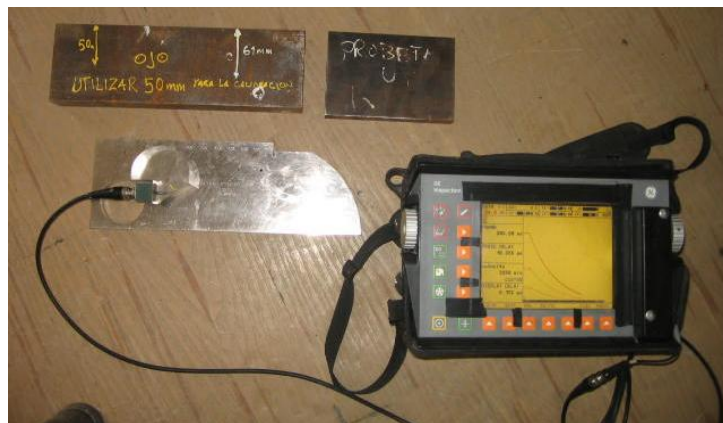
Fotografía N° 5.4. Equipo de ultrasonido usado en inspección de tubería forzada.
