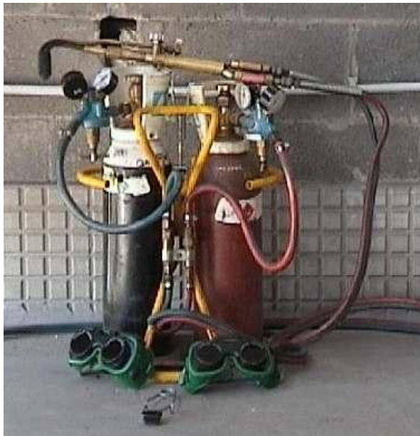
Fotografía N°4.4 Equipo de Oxicorte.
