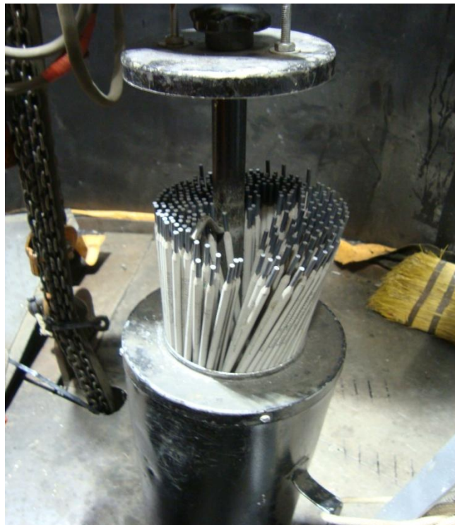
Fotografía N° 4.9. Estufas de portátiles para transporte de Electroodos
