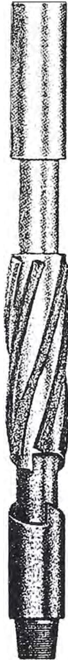
Keyseat wiper. Es una herramienta de doble acción que se baja con la sarta de perforación al momento de detectarse la formación de keyseat durante los viajes. Al bajar esta herramienta debe colocarse por debajo del keyseat, sacar tubería reciprocando para eliminar el keyseat.
