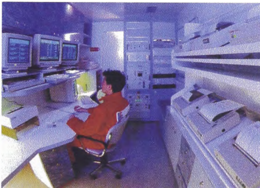
Foto 4.- Interior de una unidad de "Mudlogging" en la que se muestra a un ingeniero de presiones controlando con el sistema computarizado los parámetros de perforación de un pozo (Geoservices, 2003).
