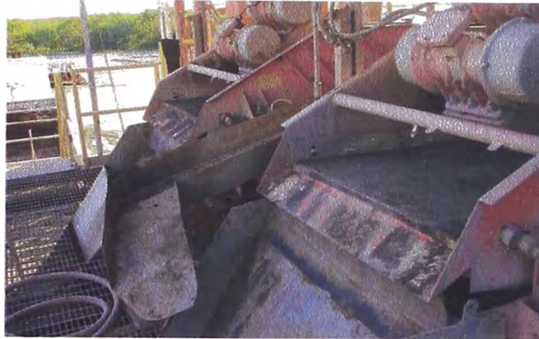
Foto 7.- Vista de las zarandas (shale shaker's) de donde se toman los recortes de perforación para su análisis y descripción (Geoservices, 2003)
