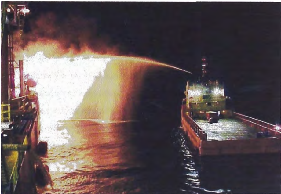
Foto 2.- Reventón en un pozo perforado en el Atlántico, en el que se puede ver que el flujo de petróleo y gas a provocado una explosión y el incendio de la plataforma de perforación (Geoservices, 2003).
