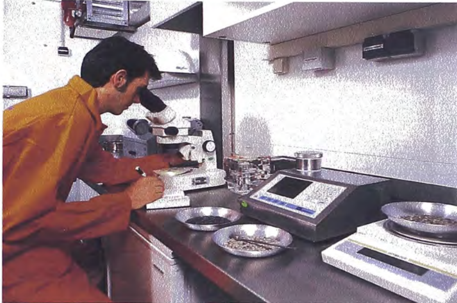
Foto 5.- Interior de una unidad de "Mudlogging" en la que se muestra a un geólogo realizando la descripción de los recortes de perforación bajo el microscópio (Geoservices, 2003).
