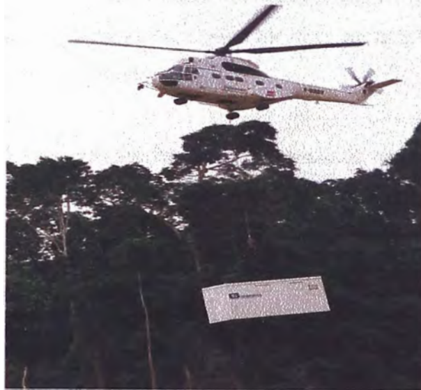
Foto 3.- Transporte con helicóptero de una unidad de "Mudlogging" a la locación de un pozo petrolero (Geoservices, 2003).
