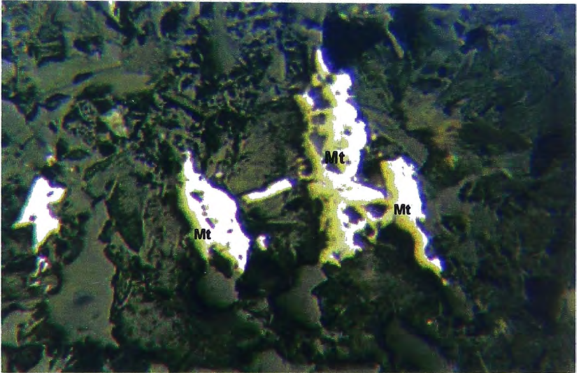
Foto N°26: Muestra PA-04, N//s, Aumento 25: Grano de magnetita limonitizada
