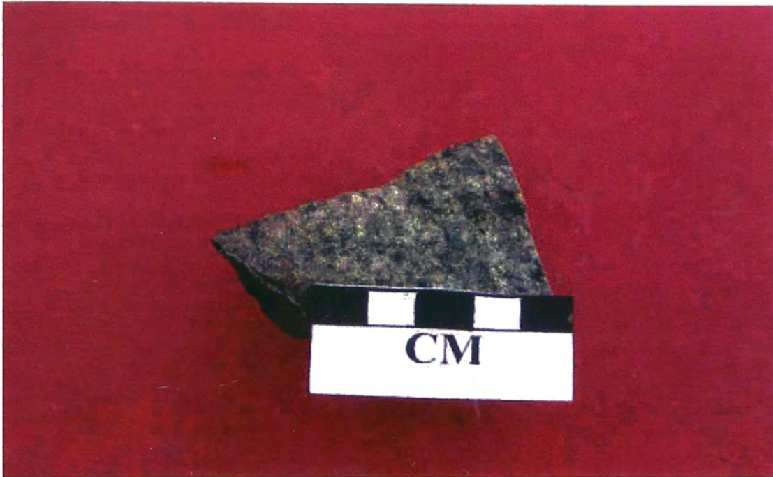
Foto N°17: Muestra DA-07, Aumento 6,3: Fenos de PLAG y Cz corroidos por la Mx de CzII, los fenos se encuentran epidotizados, tipo de roca Pórfido Granodiorítico epidotizado y cloritizado
