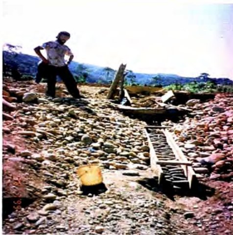
FOTO N° 04. CANAL EMPEDRADO PARA ORO PEPITICO, YANAMAYO
