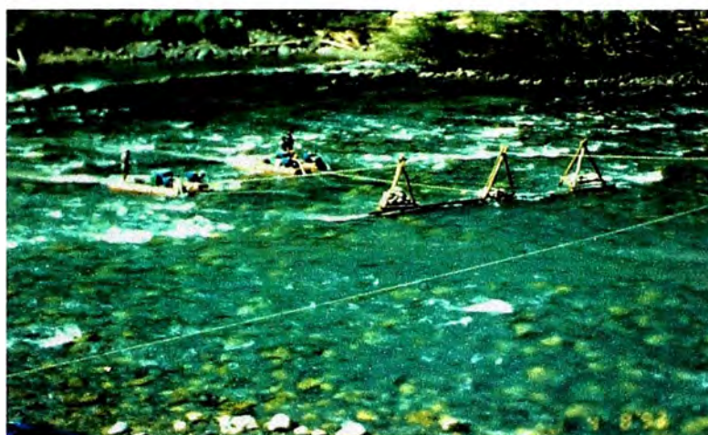
FOTO N° 19. MINIDRAGAS TRABAJANDO EN UN RAPIDO, OBSERVESE EL REPRESAMIENTO UTILIZANDO CABALLOS.
