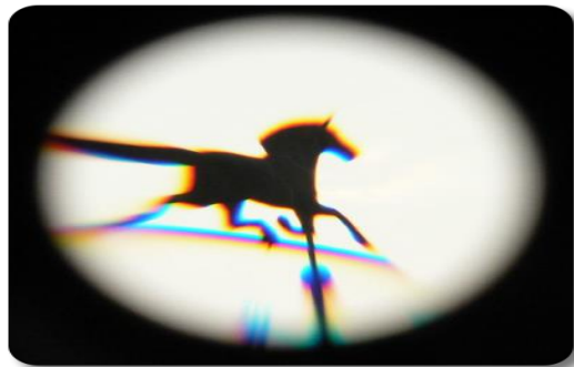
Figura 13: Ejemplo de Aberración Cromática (Fuente: Edmund Optics, Understanding Microscope and Objectives. )
