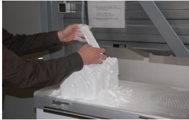
Figura 19: Ejemplo de Impresión de Sintonización por Laser (SLS) (Fuente: Tipos de Impresoras 3D / C. Escobar )
