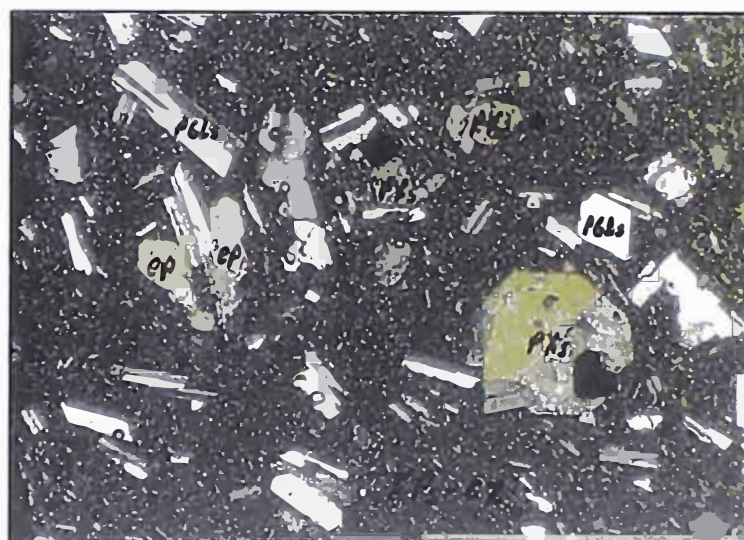
Foto # 11 Muestra N° 39; E.C.P. Machu Picchu. Aumento 150X Andesita porfírica; con fenocristales de plagioclasa (PGLs) algunos de ellos alterados a epidota (ep), con piroxenos relativamente frescos en una matriz microgranular de composición feldespática con escaso cuarzo (Cz). Los minerales opacos (OPs), se ubican diseminados en la matriz.
