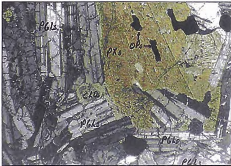
FOTO # 11 Muestra N° 18; E.C.P. Machu Picchu. Aumento 75X Diorita; con abundantes plagioclasas (PGLs) mezcladas, cristales desarrollados de piroxenos (PXs), minerales opacos (OPs), reemplazando parcialmente a los piroxenos y cloritas (CLOs) por alteración de los máficos.
