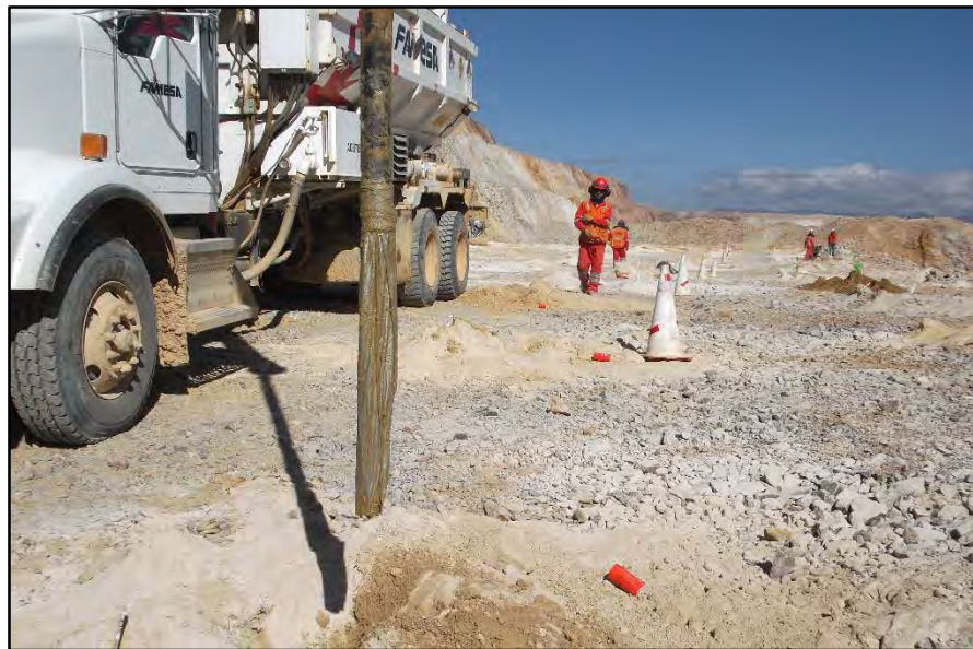
Fig. 3.5 Muestra la imagen de un camión fábrica, fabricando SANG (Fuente Mina La Arena-Tajo Calaorco)
