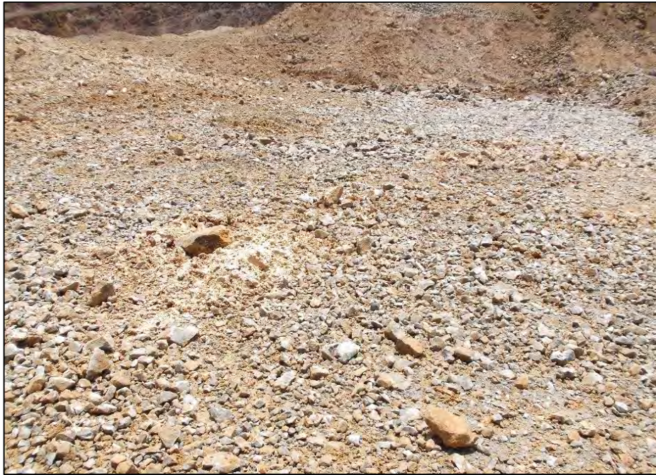
Fig. 3.7 Muestra una imagen donde se utilizó SANG con una densidad de 1.05 g/cm 3 en una Arenisca (Fuente Mina La Arena-Tajo Calaorco).
