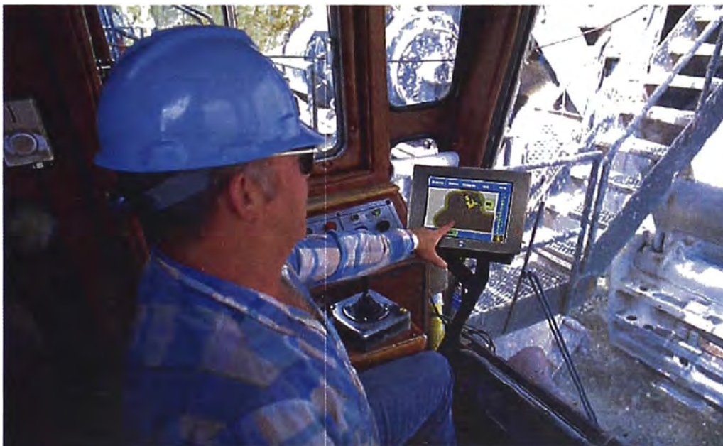
Fig. 023 | Panel CGC del Sistema HPGPS en cabina de la Pala
