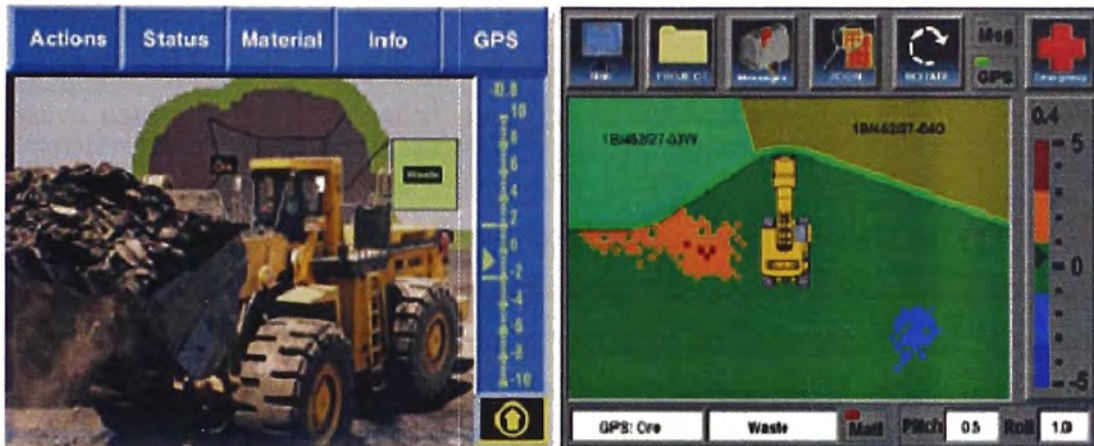
Fig. 025 | Monitoreo de los Pisos de las Palas
