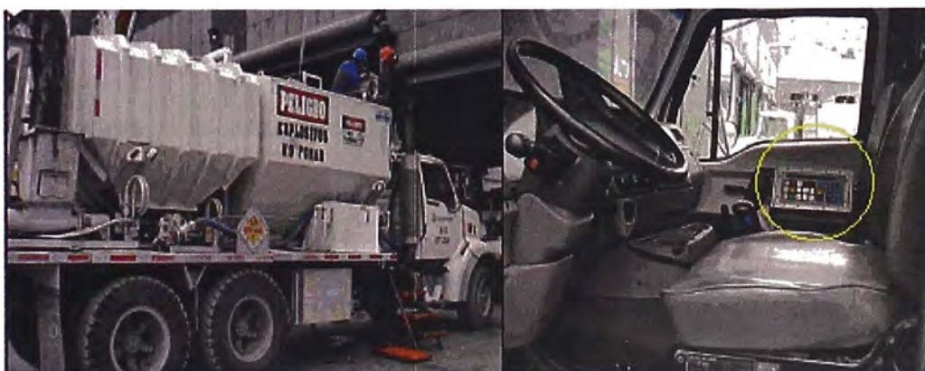
Fig. 021 Sistema de Registro de Explosivos
