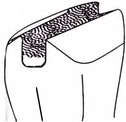
Rotura en forma de silla. Queda metal duro en el fondo de la ranura
