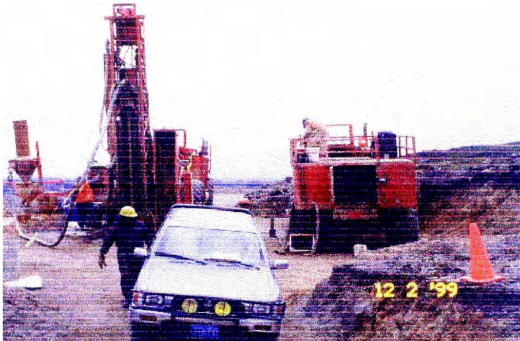
Foto 15. Máquina de perforación de aire reverso RCD iniciando la fase I de perforación en Quilish.
