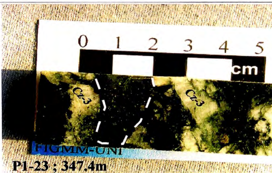
B : Esquistos del Complejo Marañón hidrotermalizado conteniendo un fragmento del dique basáltico (matriz porfirítica).
