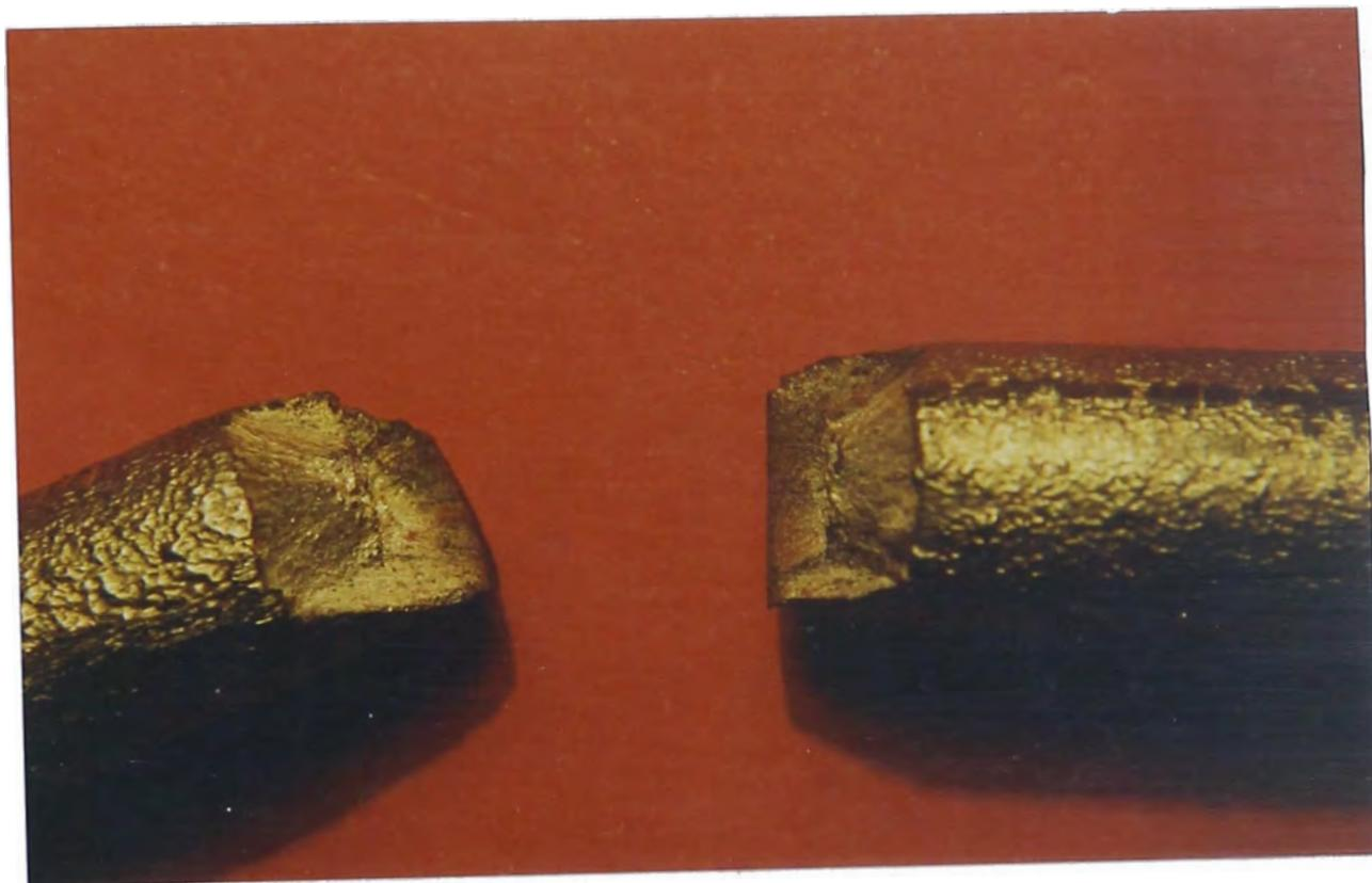
Con la macrografía se puede observar el rechupe formado en el riser por la aleación.
