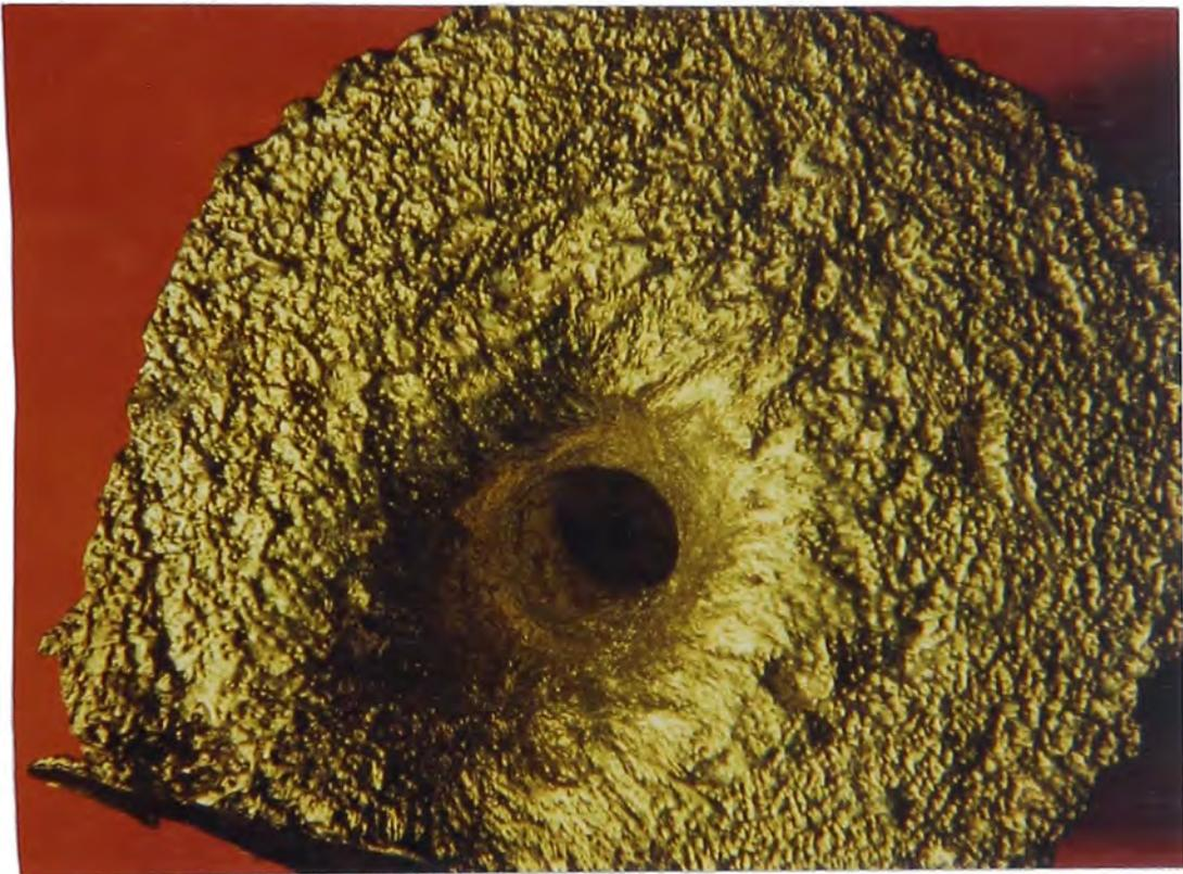
Secuencia de la solidificación progresiva durante el enfriamiento de la aleación de corto rango de solidificación. Notese la demarcación entre las fases líquida y sólida.
