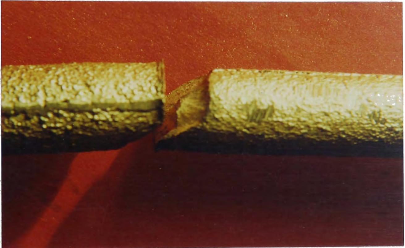
Se observa una fractura dúctil. También el cizallamiento y la estructura fibrosa.
