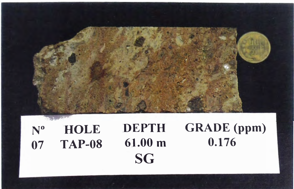
Foto No 3 Roca piroclástica, afectada por fluidizaciones hidrotermales.
