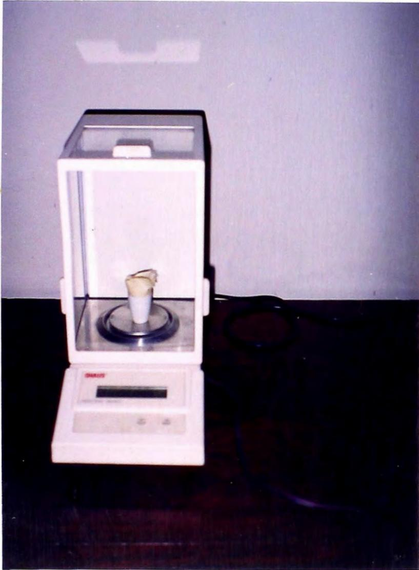
Peso del sulfato de bario, filtrado y seco.
