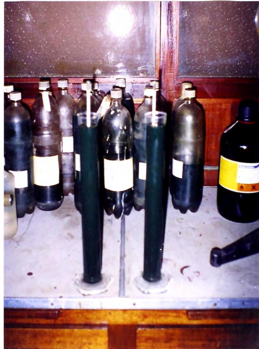
**Derecha:** Posición errado del hidrómetro, está pegado a la pared de la probeta.
