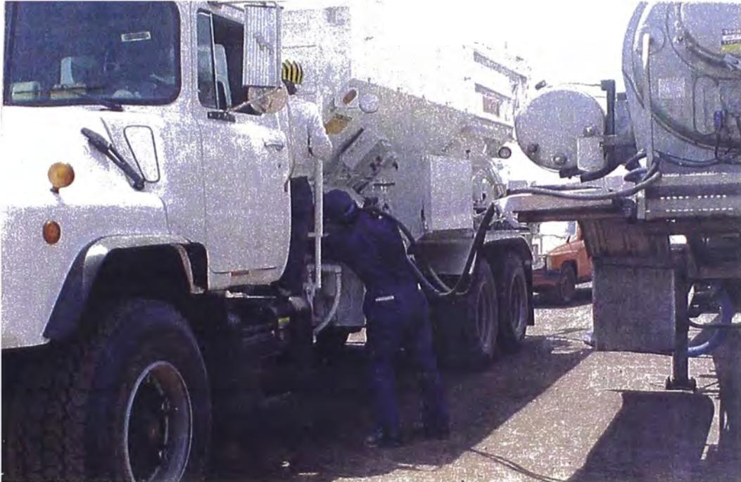
**FIG. 3 - 4 : Secuencias de conexión de los terminales auxiliares, para poner en funcionamiento la bomba del POLAR TANK.**
