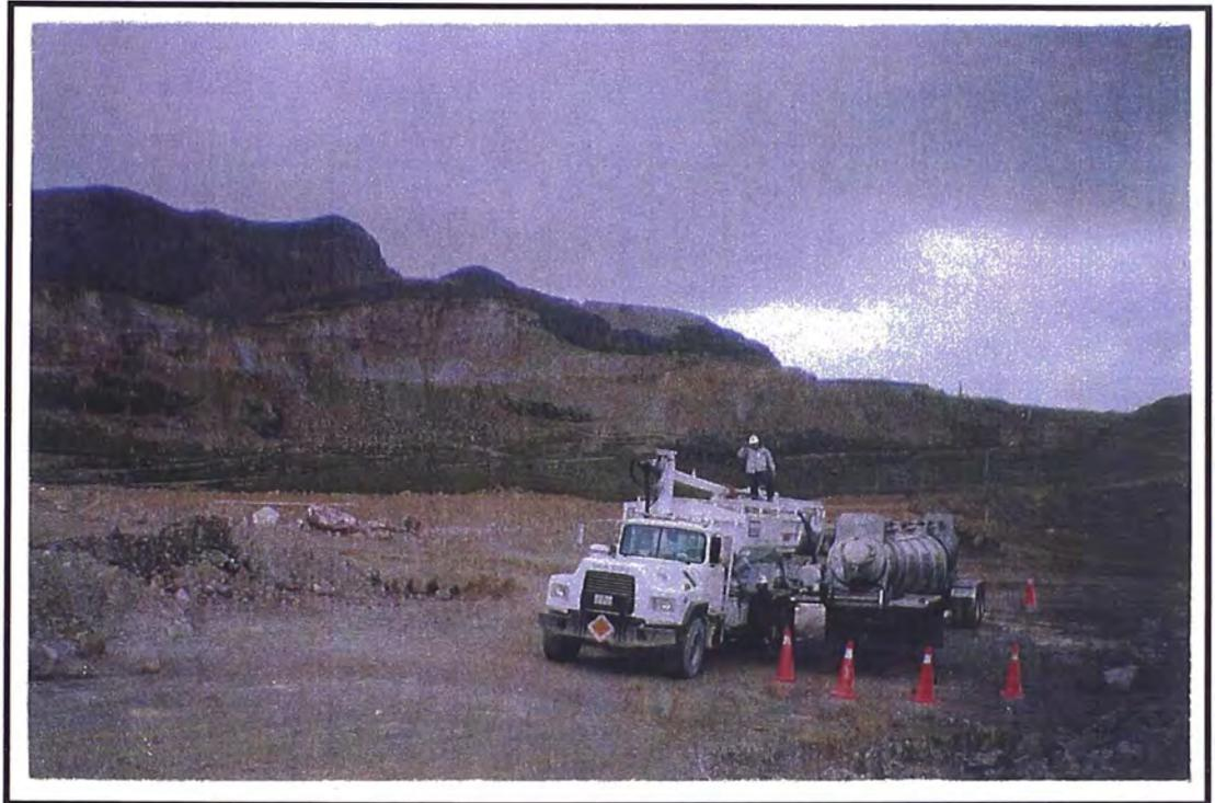
**FIG. 1 - 2 : Secuencias del parqueo e instalación de la manguera de descarga del APEXSA MAT del camión cisterna POLAR TANK al camión mezclador-bombeador TREAD. Al fondo se observa Carachugo Norte zona de una de las pruebas. Al inicio la malla de perforación fué 5.75 x 5.75 m. y al final de la prueba se llegó a establecer la malla 6 x 6 m.**
