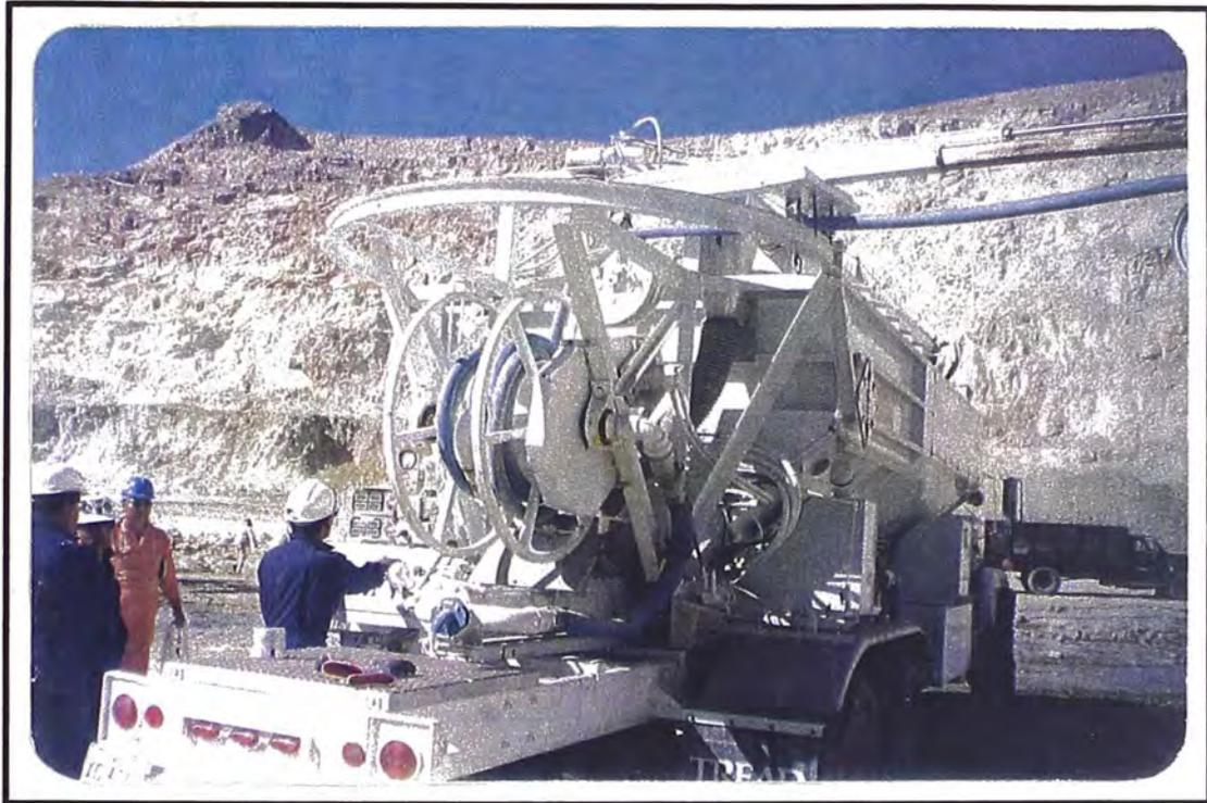
**FIG. 5 - 6 : Secuencias del carguío mecanizado utilizando el sistema bombeable del camión TREAD.**
