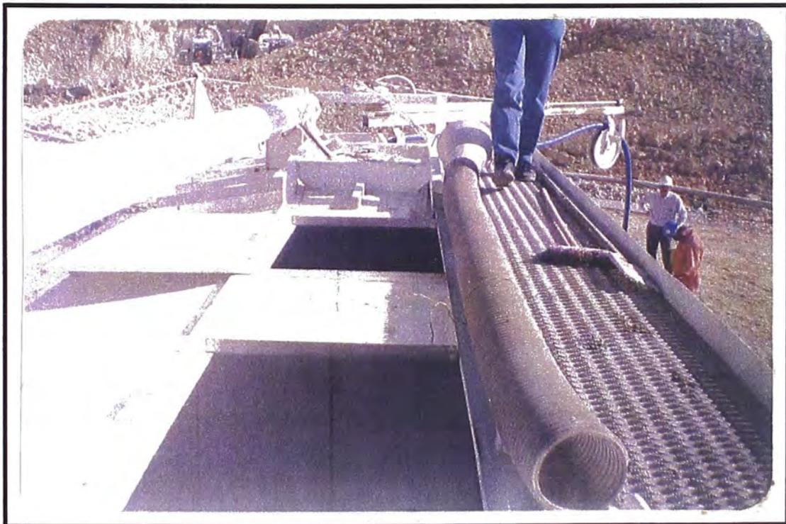
**Fig. 2 :** Los dos compartimientos de nitrato de amonio y al fondo se observa el compartimiento de la emulsión.
