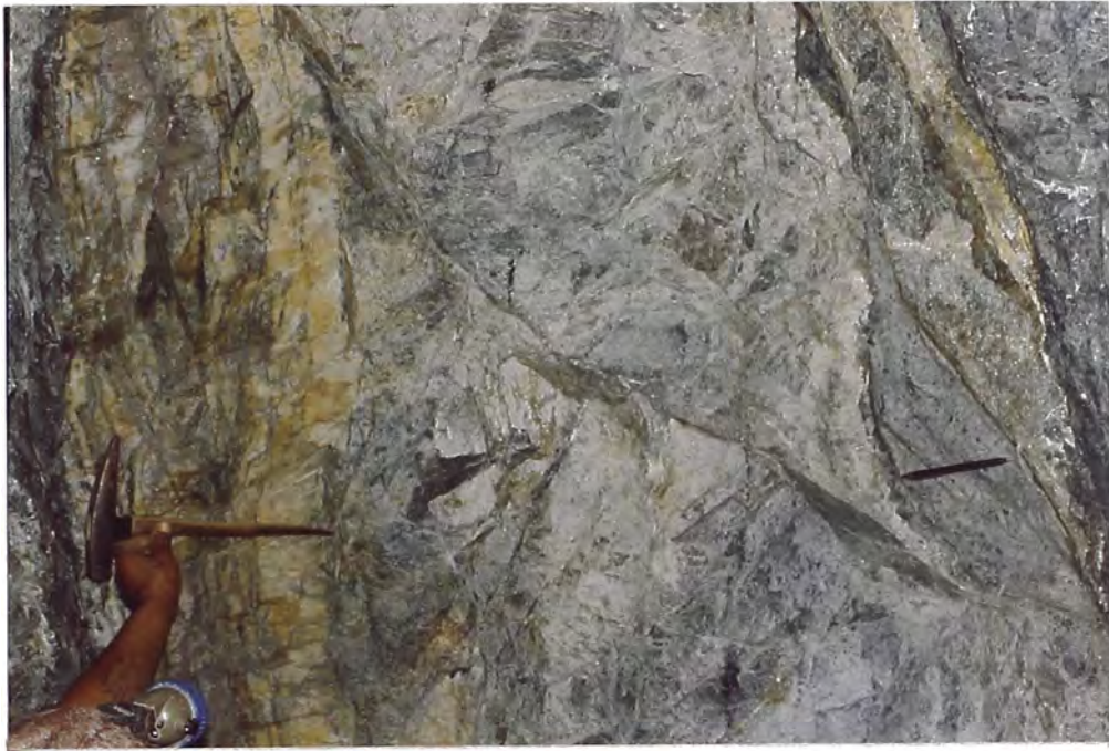
FOTO 5. Emplazamiento principal oeste-noroeste (izquierda) con lazo cimoides (derecha), con dique alterado silicificado y cloritizado. (Niv. 87 : tajo 8198 - veta San Juan).
