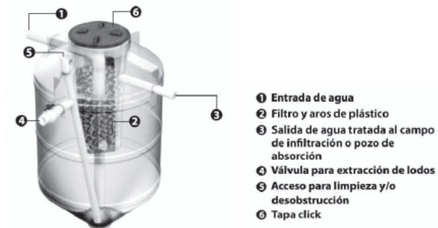
Imagen N° 2.5 - Componentes del Biodigestor
