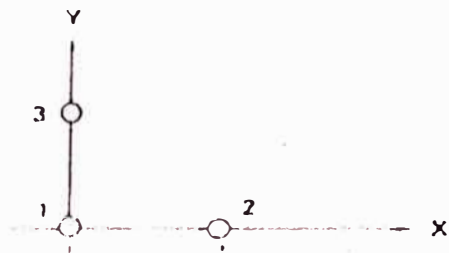
Geometria de los Hidrófonos Vista de arriba
